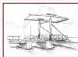
รูปที่ 4 ลักษณะของสะพานหก ซึ่งเป็นรูปแบบที่ใช้ในสมัยของปลายรัชกาลที่ 4
