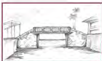
รูปที่ 5 สะพานที่ตอม่อทำจากอิฐ และพื้นทำจากไม้
