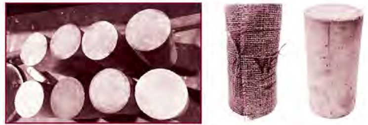
รูปที่ 3 ตัวอย่างคอนกรีตรูปทรงกระบอกใช้ในการทดสอบรับแรงอัด
