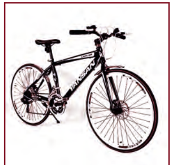
รูปที่ 8 จักรยานเสือภูเขา จะออกแบบให้เพิ่มโช๊ค (Shock Absorber) เพื่อลดแรงกระแทกในการปั่นในที่ขรุขระ (ที่มา : http://dreamslotto.com )
