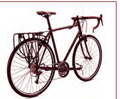
รูปที่ 9 จักรยานท่องเที่ยว จะออกแบบมาเพื่อใช้ในการปั่นท่องเที่ยวไกลๆ และมีตะแกรงไว้วางของสัมภาระ (ที่มา : http://www.snbike.com )
