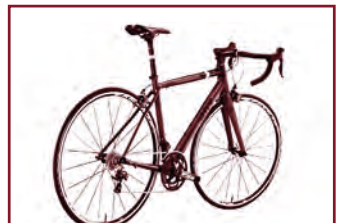
รูปที่ 7 จักรยานเสือหมอบเพื่อการแข่งขันในยุคปัจจุบัน ถูกออกแบบให้เบาและลดแรงต้านอากาศ (ที่มา : http://edsakjd.blogspot.com )
