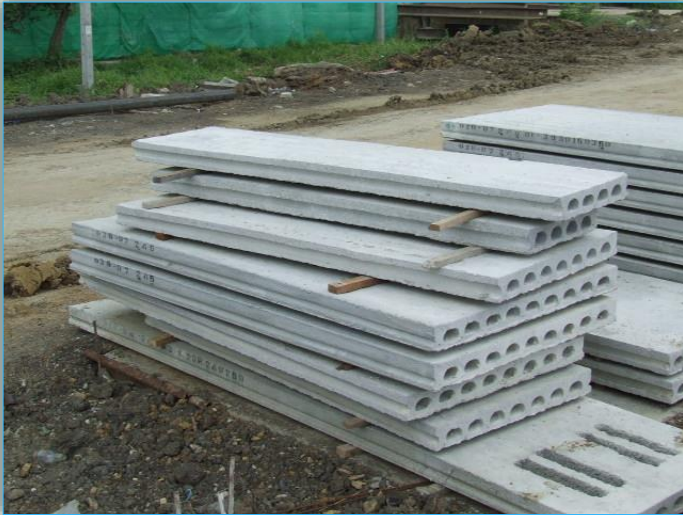
HOLLOW CORE SLAB ความหนาเริ่มที่ประมาณ 8 cm. ถึง 30 cm.
