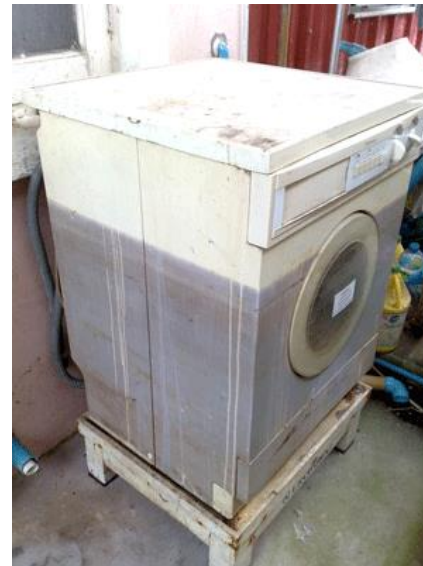
ภาพอุปกรณ์ไฟฟ้าชำรุดเสียหายหลังน้ำท่วมเป็นเวลานาน
