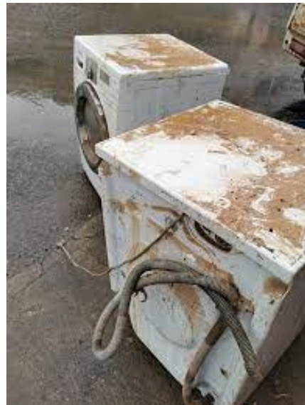
ภาพอุปกรณ์ไฟฟ้าชำรุดเสียหายหลังน้ำท่วมเป็นเวลานาน
