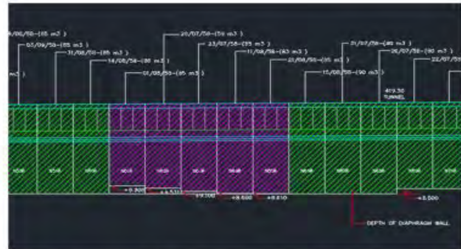
รูปถ่ายที่ 1-6 แสดงแบบผนังทึด ( DIAPHRAGM WALL ) ที่ขุดเจาะ ไม่ถึงระดับที่ออกแบบไว้
