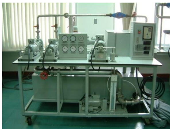
ชุดทดสอบ Multi Pumps Test
