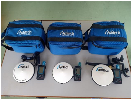
ชุดสำรวจโดยใช้ดาวเทียม(3 Station)
