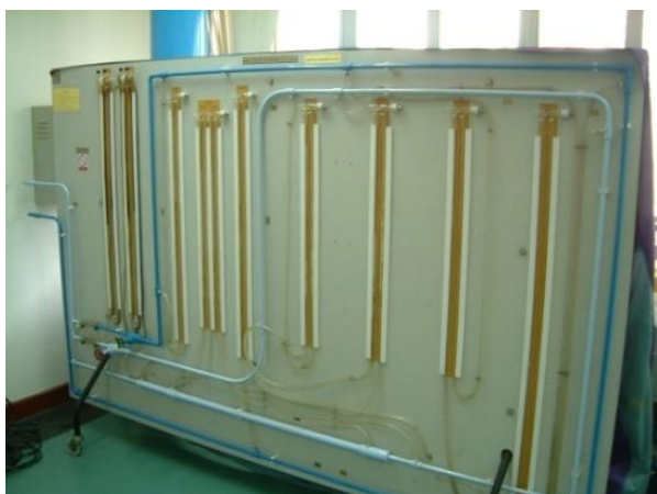
ชุดทดสอบการสูญเสียภายในท่อ (Losses in Pipe)
