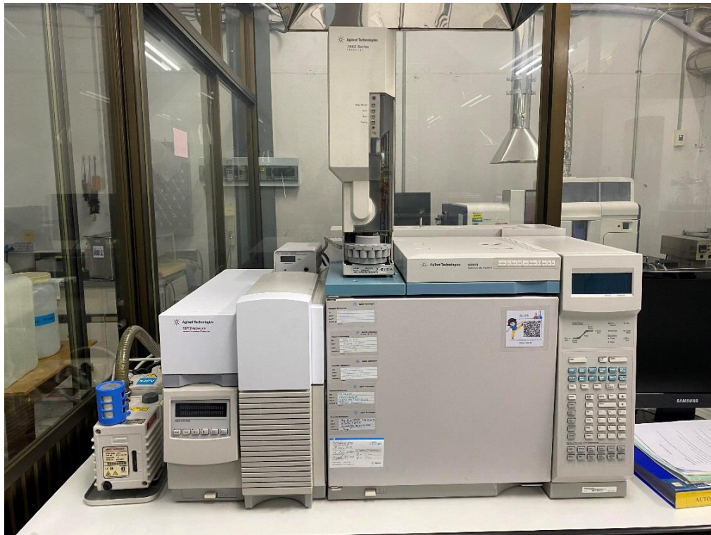
เครื่องวิเคราะห์ปริมาณสารอินทรีย์ (Gas Chromatography/Mass Spectrophotometer)
