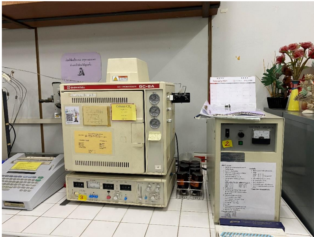
เครื่องแก๊สโครมาโทกราฟี (Gas Chromatography) สำหรับวิเคราะห์สารประกอบที่เป็นไอ
