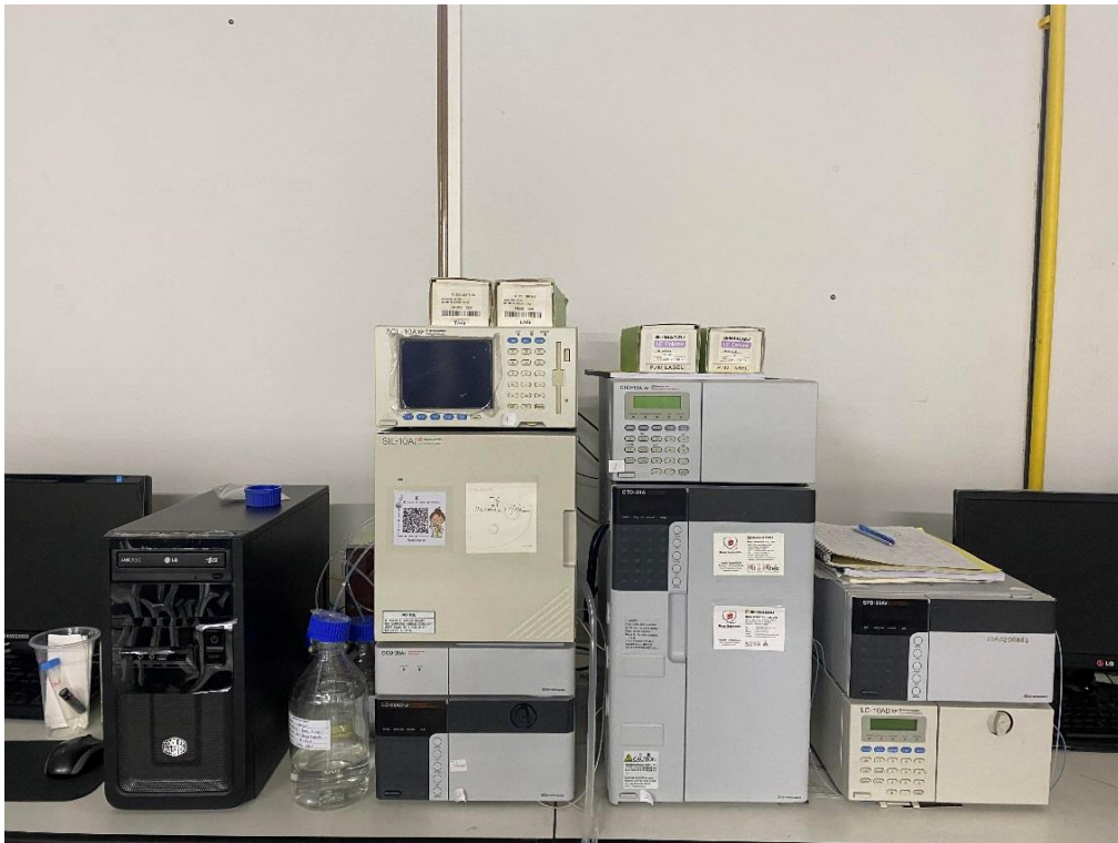
เครื่องวิเคราะห์ปริมาณไอออน (Ion Chromatography)
