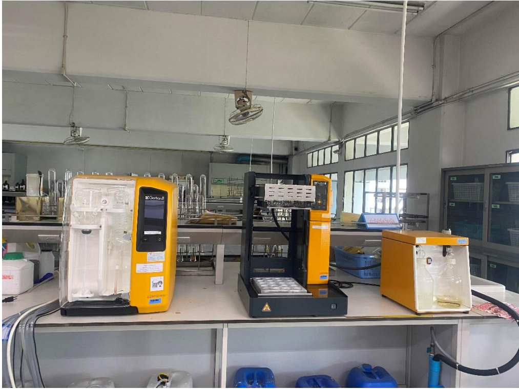
เครื่องวิเคราะห์ปริมาณไนโตรเจน (Kjeldahl Digestion Unit)
