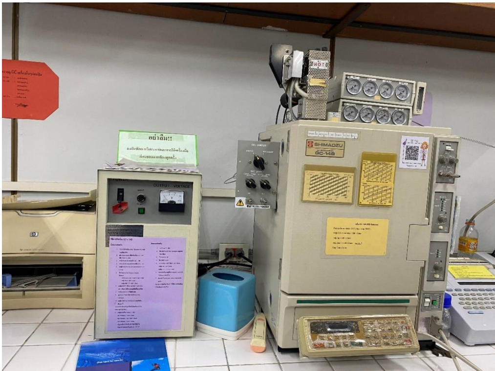
เครื่องแก๊สโครมาโทกราฟี (Gas Chromatography) สำหรับวิเคราะห์ปริมาณก๊าซ
