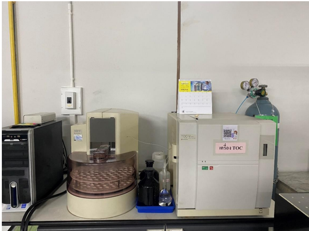
เครื่องวิเคราะห์ปริมาณคาร์บอนทั้งหมด (Total Organic Carbon)
