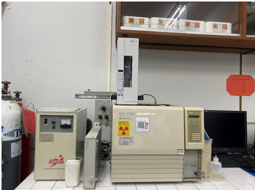
เครื่องแก๊สโครมาโทกราฟี (Gas Chromatography) สำหรับวิเคราะห์ปริมาณสารอินทรีย์
