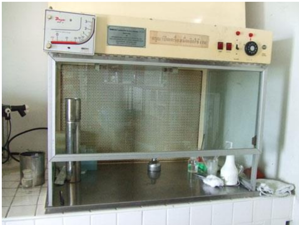
ตู้ดูดควัน/ไอระเหย ขณะเตรียมสารเคมีสำหรับเลี้ยงเชื้อ
