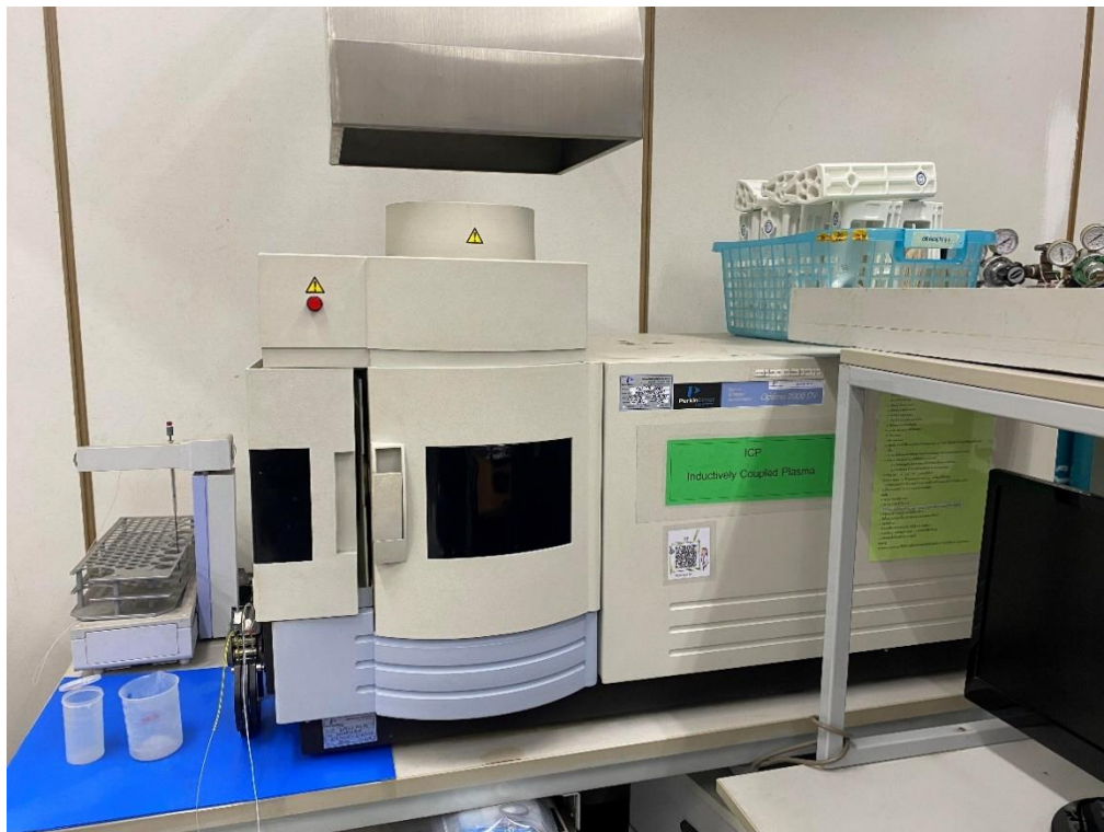
เครื่องวิเคราะห์ปริมาณโลหะหนัก (Inductively Coupled Plasma)
