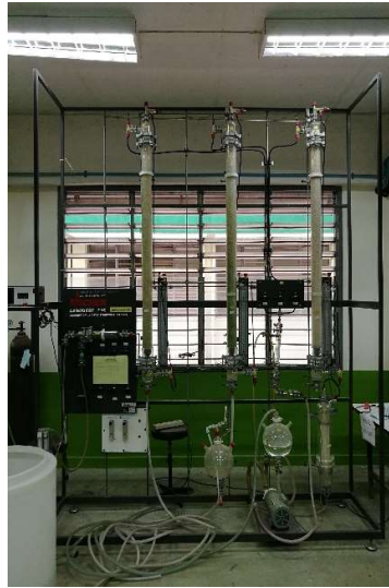
รูปที่ 1.19 หอดูดซึมแก๊ส
