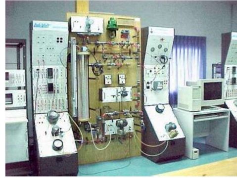
รูปที่ 1.32 หน่วยทดลองการควบคุมระดับของเหลว
