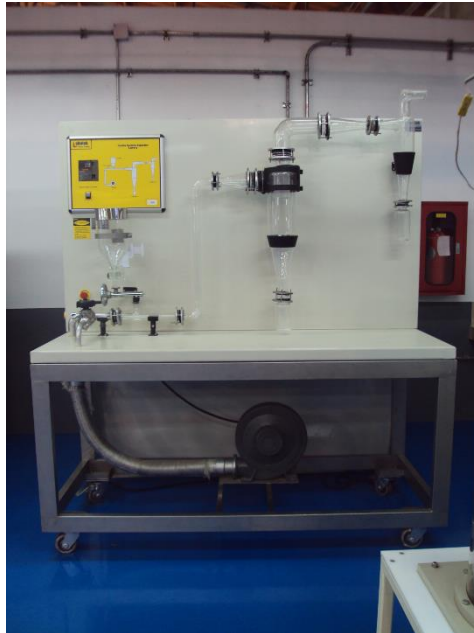
ชุดอุปกรณ์ทดลองสำหรับ การแยกแบบไซโคลน (Cyclone Separator Apparatus)
