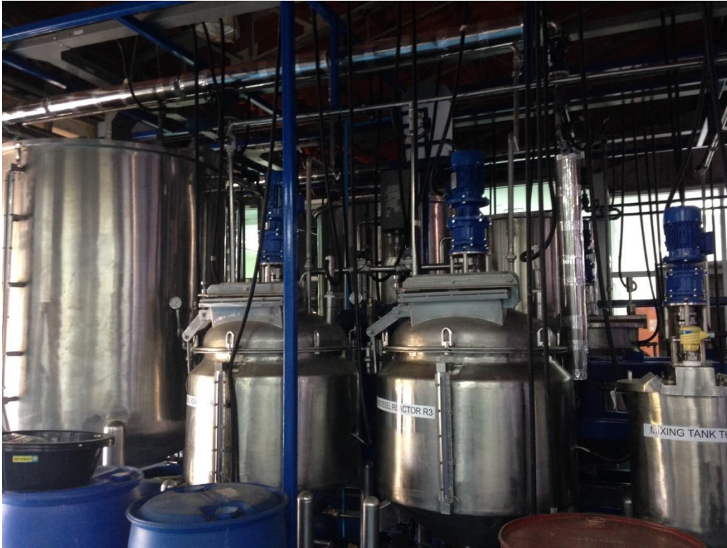
โรงงานต้นแบบ (Pilot plant) สำหรับการผลิตไบโอดีเซลขนาด 250 ลิตร สำหรับรายวิชาโครงการวิศวกรรมเคมีและเคมีเภสัชกรรมและรายวิชาปฏิบัติการควบคุมกระบวนการอุตสาหกรรม
