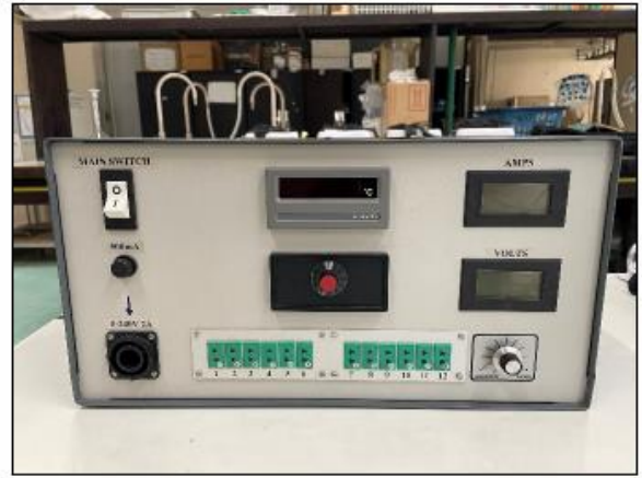
24. ชุดสาธิตการนำพาความร้อน
