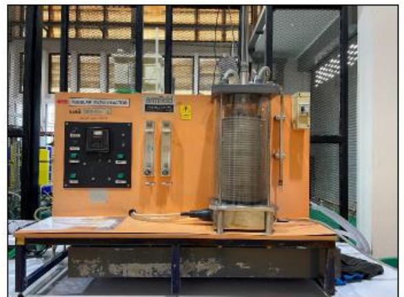
22. ชุดสาธิตการเกิดปฏิกิริยาในถังปฏิกรณ์แบบท่อ
