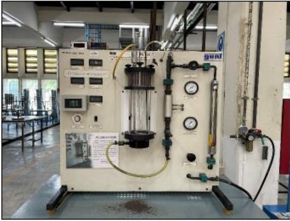
23. ชุดสาธิตการถ่ายเทความร้อนในฟลูอิดไดซ์เบด
