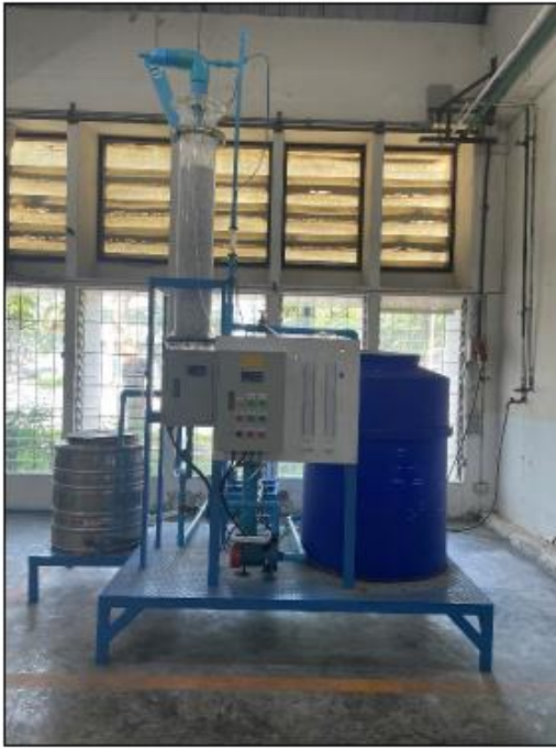
13. หอดูดซึม/ไล้ก๊าซ
