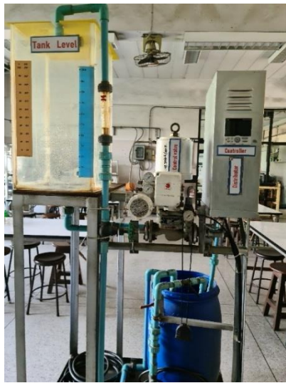
รูปที่ 1.10 ชุดทดลอง Level Control
