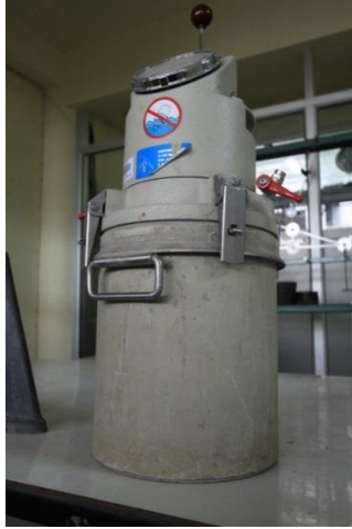
- จุดทดสอบการหาค่าหน่วยน้ำหนักของคอนกรีต
