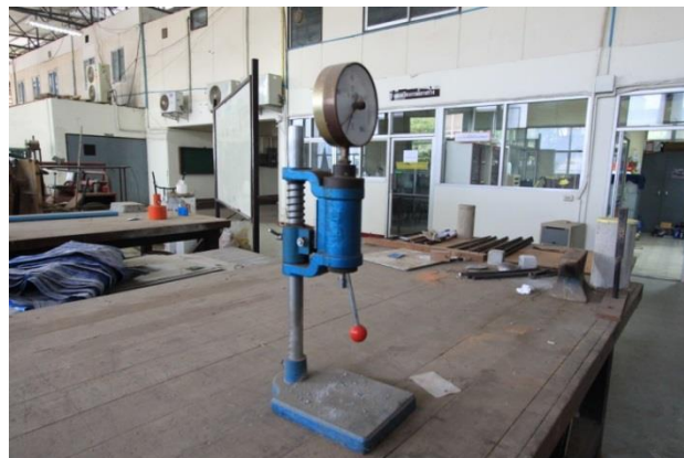
- จุดทดสอบเวลาการก่อตัวของคอนกรีต
