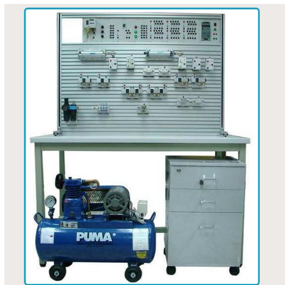
ชุดทดสอบระบบนิวเมติกควบคุมด้วย PLC
