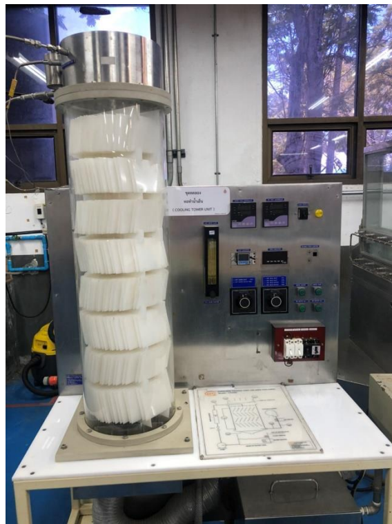
เครื่องทดสอบ Cooling tower (มีอยู่ที่อาคารเครื่องมือวิทยาศาสตร์และเทคโนโลยี 2)
