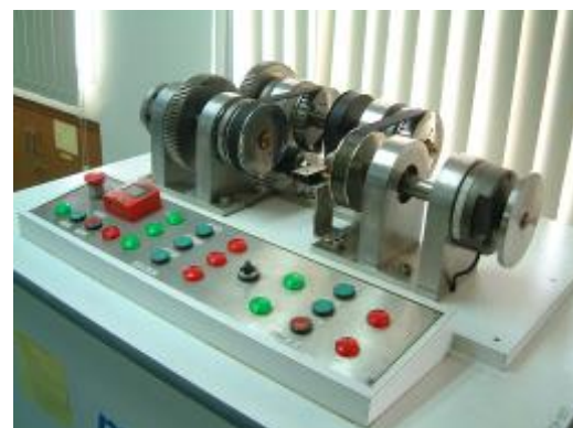
ชุดสาธิตการส่งกำลังด้วยคลัชต์ไฟฟ้าและเบรกไฟฟ้า
