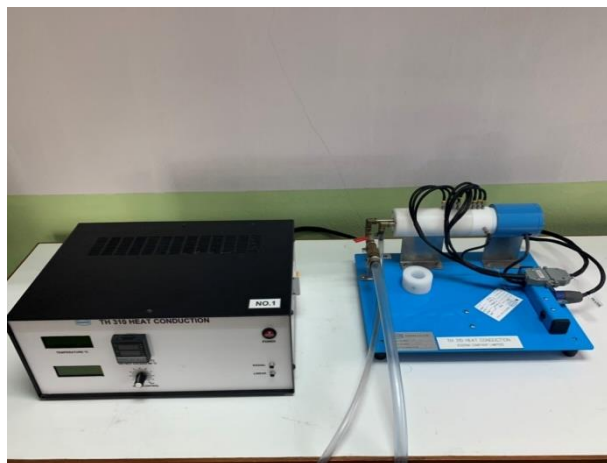
เครื่องทดสอบค่าการนำความร้อนด้วยวิธีการถ่ายเทความร้อนตามแนวแกน X
