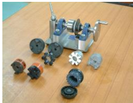
ชุดสาริตชินโครนัสคลัชต์ด้วยด้ามมือ
