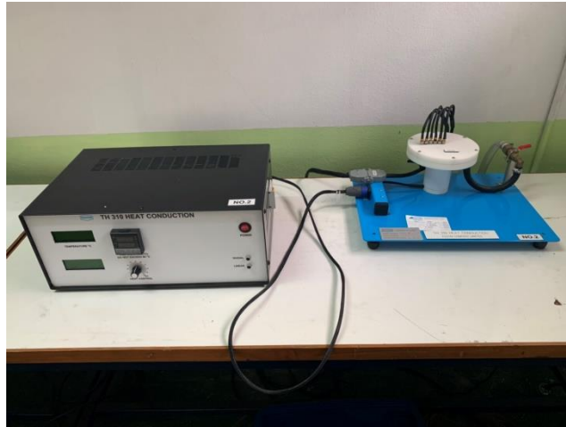
เครื่องทดสอบค่าการนำความร้อนด้วยวิธีการถ่ายเทความร้อนตามแนวรัศมี
