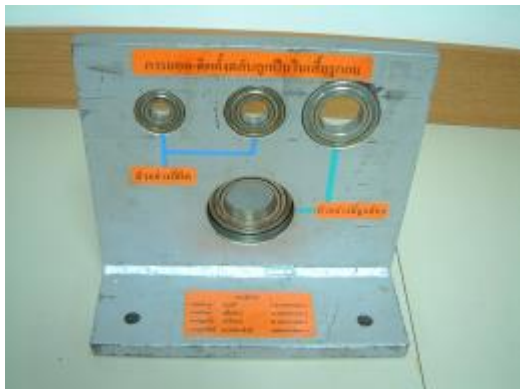
ชุดสาธิตการถอด-ติดตั้งตลับลูกปืนในเสื้อรูกลม
