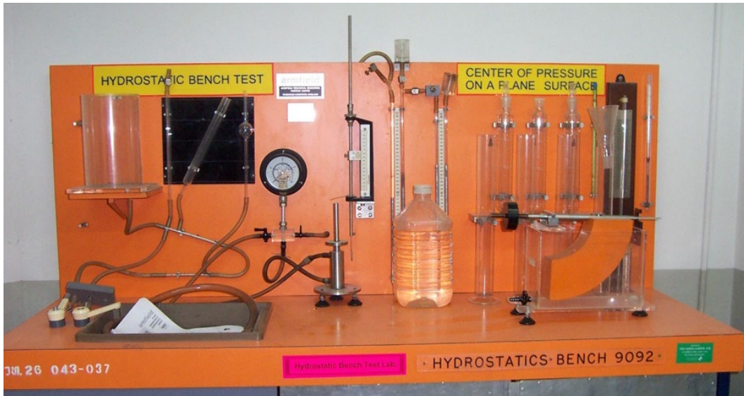
หัวข้อการทดลอง 1. จุดศูนย์กลางของความดันบนแผ่นเรียบ 1.7 Hydrostatics Bench Test Set
