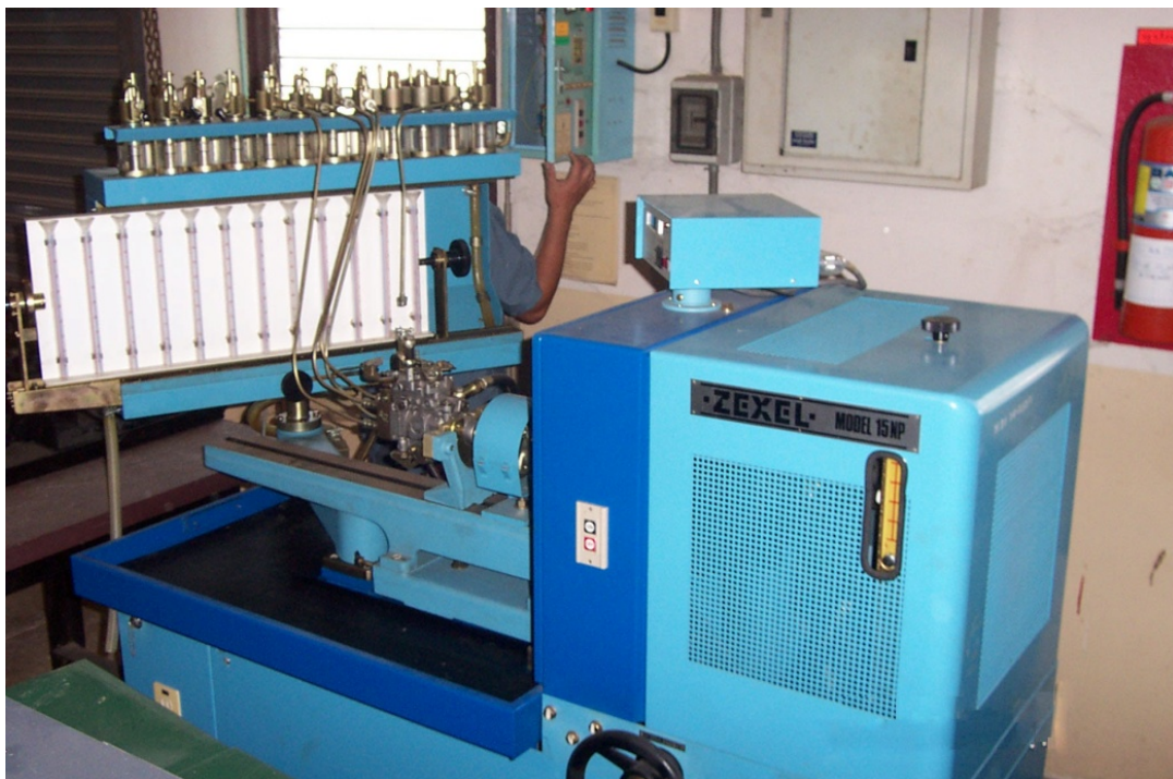
หัวข้อการทดลอง 1. การทดสอบปั๊มและหัวฉีดของเครื่องยนต์ดีเซล 2.21 Injector Testing Set
