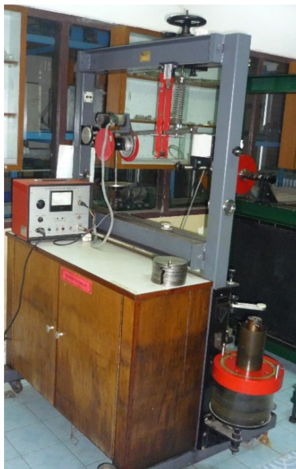
หัวข้อการทดลอง 1. การสั่นสะเทือนแบบอิสระ 2. การสั่นสะเทือนแบบบังคับ 3. การสั่นบิด 4. สปริงชด 4.2 Vibration Test Set
