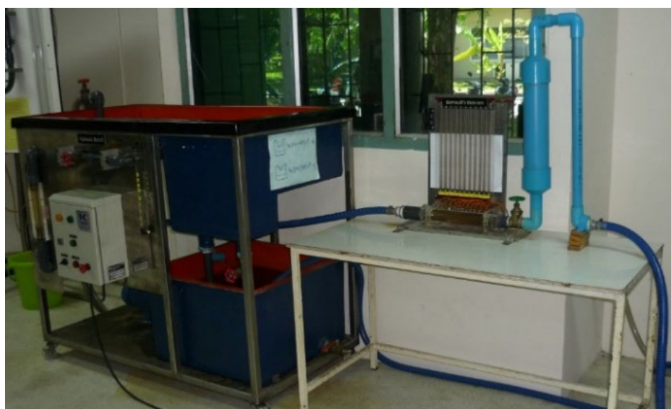
หัวข้อการทดลอง 1. หลักการของเบอร์นูลลี 1.13 Demonstration of Bernoulli's law Set
