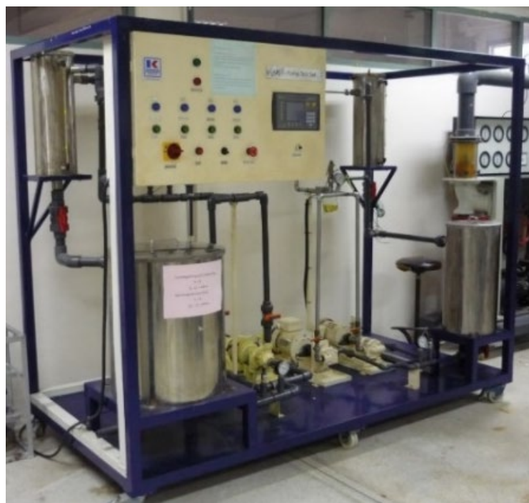
หัวข้อการทดลอง 1. การทดสอบปั๊มแบบต่างๆ 1.2 Multi-pump Test Set
