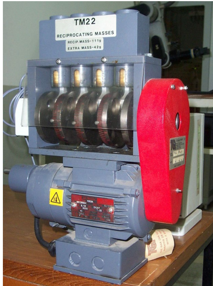
หัวข้อการทดลอง 1. การปรับสมดุลของเครื่องยนต์แบบลูกสูบชัก 2.20 Reciprocating Masses Set
