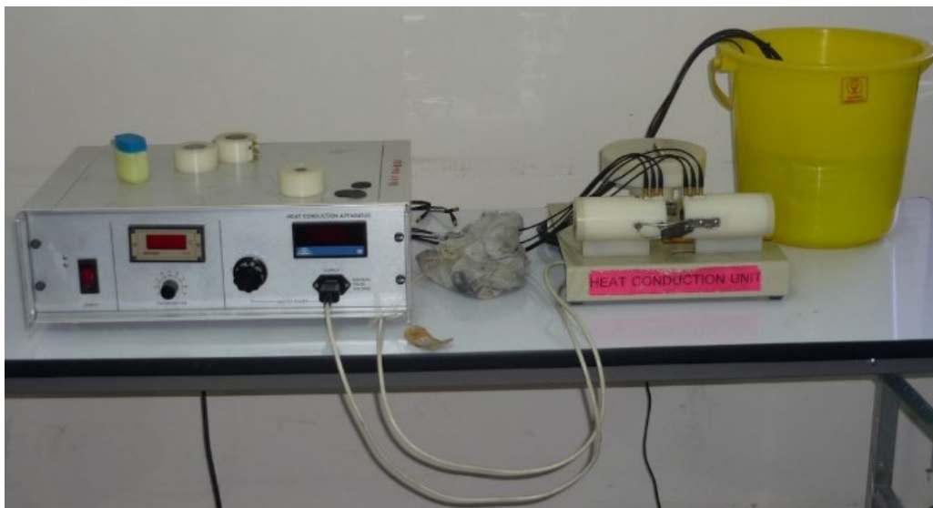
หัวข้อการทดลอง 1. การนำความร้อน 3.1 Heat Conduction Set
