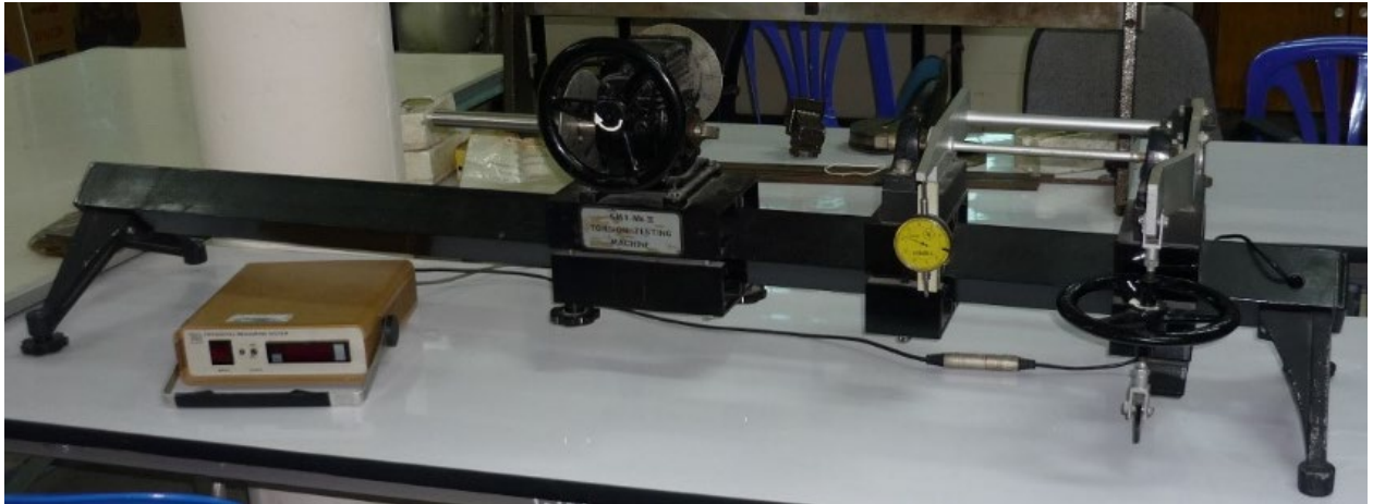
หัวข้อการทดลอง 1. การทดสอบการบิดวัสดุ 5.3 Torsion Test set
