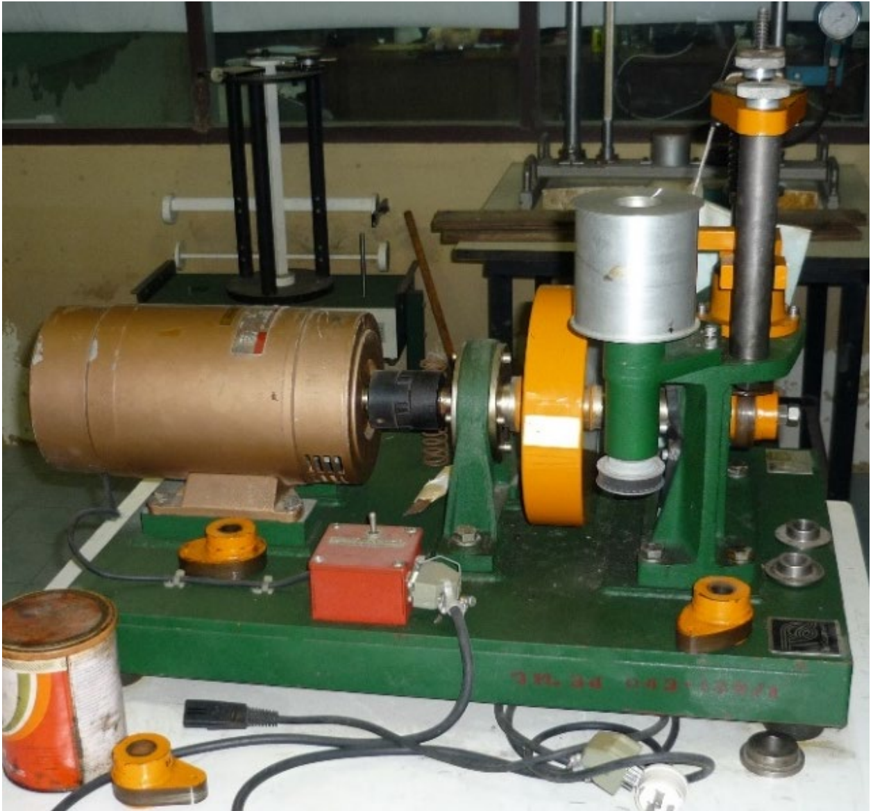
หัวข้อการทดลอง 1. การวิเคราะห์ล้อกลเบี้ยว 4.5 Cam Analysis Set
