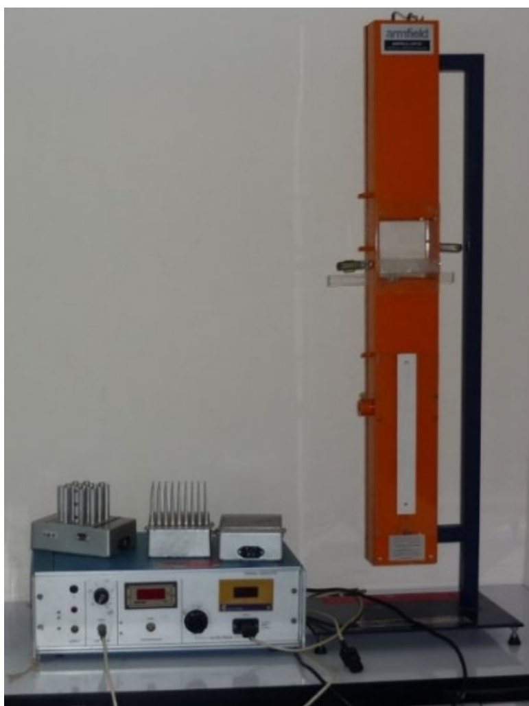
หัวข้อการทดลอง 1. การพาความร้อนแบบอิสระและแบบบังคับ 3.2 Free and Forced Heat Convection Set
