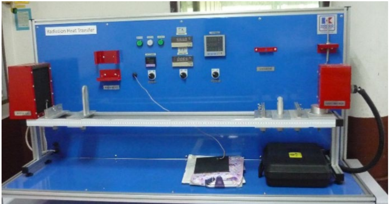
หัวข้อการทดลอง 1. การแผ่รังสีความร้อน 3.3 Heat Radiation Set
