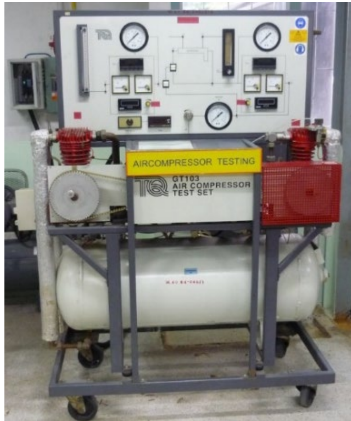
หัวข้อการทดลอง 1. การทดสอบเครื่องอัดอากาศ 1.7 Air Compressor Set
