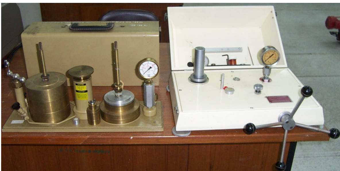
หัวข้อการทดลอง 1. การปรับเทียบความดันสถิตย์ของเกจวัดความดันแบบบูดอง 1.10 Hydrostatic Bench Calibration of a bourdon-type Pressure gauge Test Set
