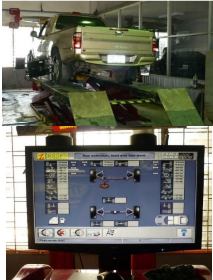
หัวข้อการทดลอง 1. การตั้งศูนย์ล้อรถยนต์ 2.18 Wheel Alignment Machine Set
