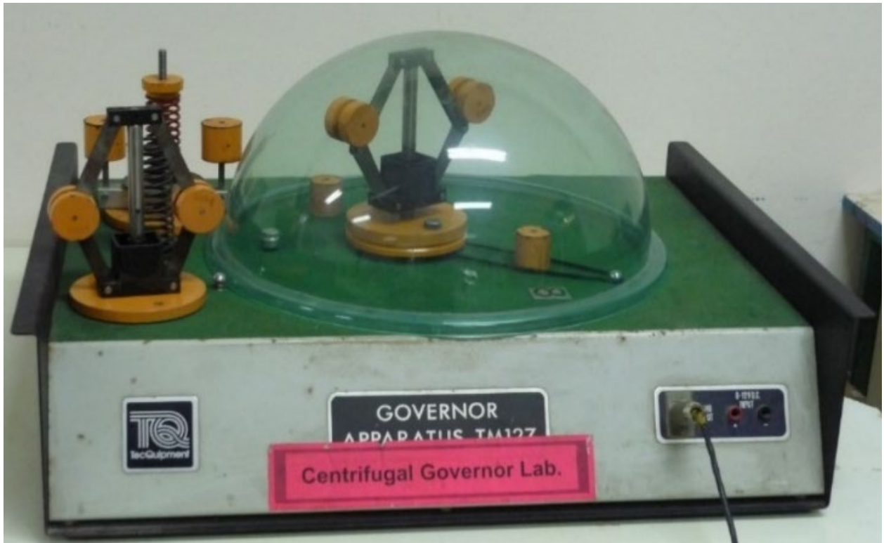
หัวข้อการทดลอง 1. กัฟเวอร์เนอร์ 4.7 Governors Apparatus Set
