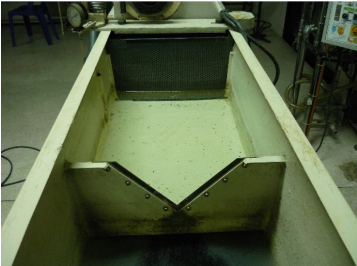
หัวข้อการทดลอง 1. การหาอัตราการไหลของน้ำผ่านฝาย 1.15 Flow Over Weirs Apparatus Set
