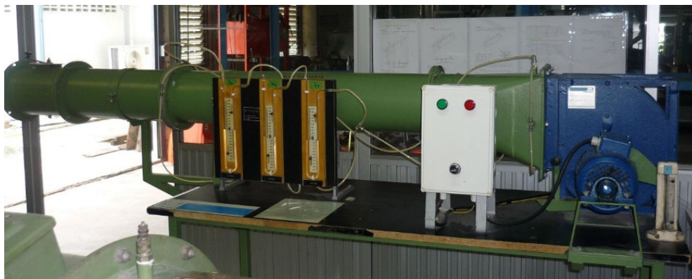
หัวข้อการทดลอง 1. การทดสอบพัดลมแบบแรงเหวี่ยงหนีศูนย์กลาง 1.11 Centrifugal Fan Performance Test Set
