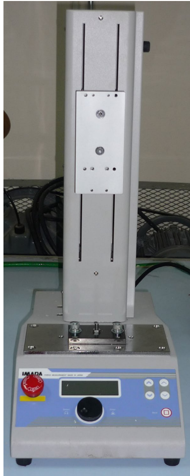
หัวข้อการทดลอง 1. การทดสอบการดึงวัสดุและการทดสอบความแข็งวัสดุ 5.5 Universal Testing Machine
