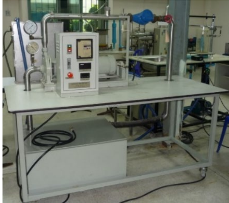
หัวข้อการทดลอง 1. การทดสอบปั๊มแบบแรงเหวี่ยงหนีศูนย์กลาง 1.1 Centrifugal pump Test Set
