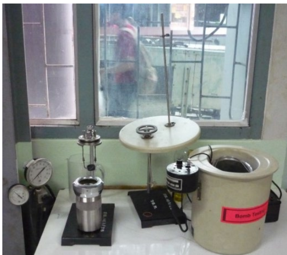
หัวข้อการทดลอง 1. การหาค่าความร้อนเชื้อเพลิง 3.6 Bomb Calorimeter Set
