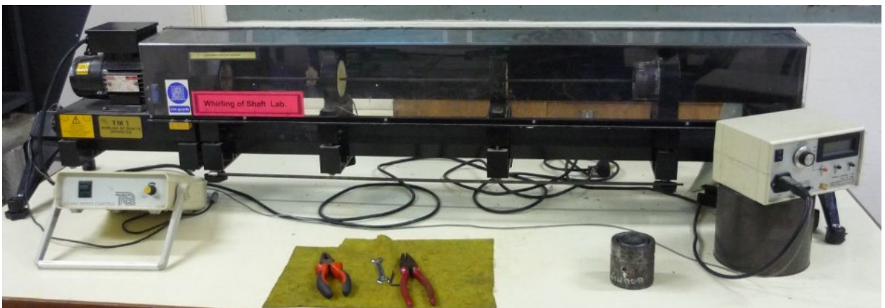
หัวข้อการทดลอง 1. การแกว่งตัวของเพลา 4.6 Whirling of Shaft Apparatus Set
