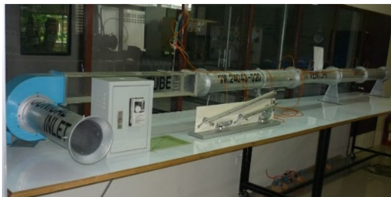
หัวข้อการทดลอง 1. การทดสอบกังหันเพลตัน 2. การทดสอบกังหันฟรานซิส 1.3 Pelton & Francis Turbine Test Set
