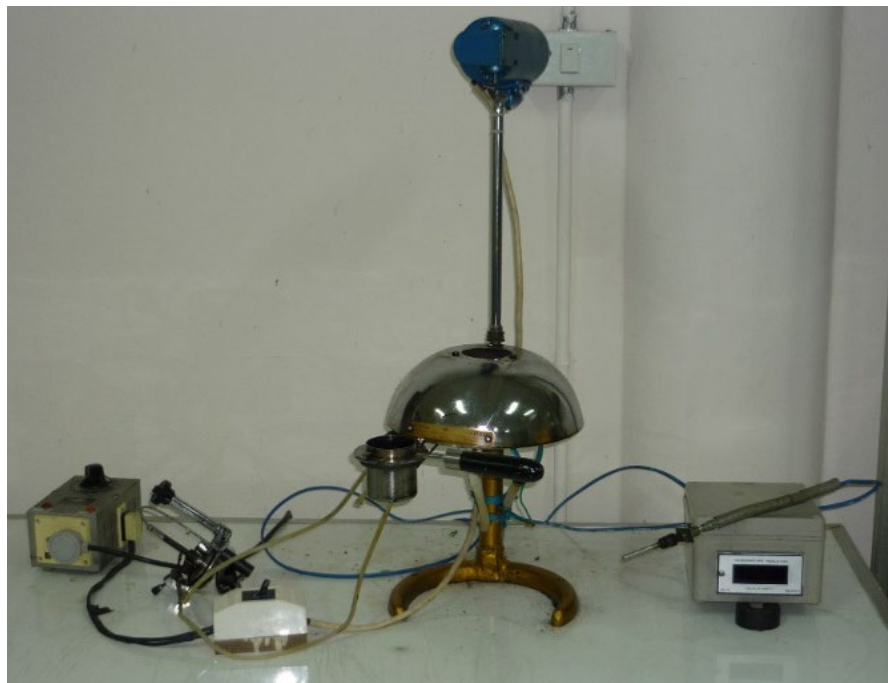
หัวข้อการทดลอง 1. การหาจุดวาบไฟและจุดติดไฟ 2.14 Flash Point and Fire Point Set
