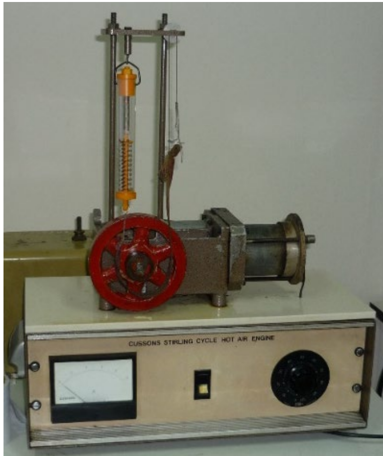
หัวข้อการทดลอง 1. เครื่องยนต์ที่ทำงานตามวัฏจักรสเตอร์ลิง 3.13 Stirling Engine Set
