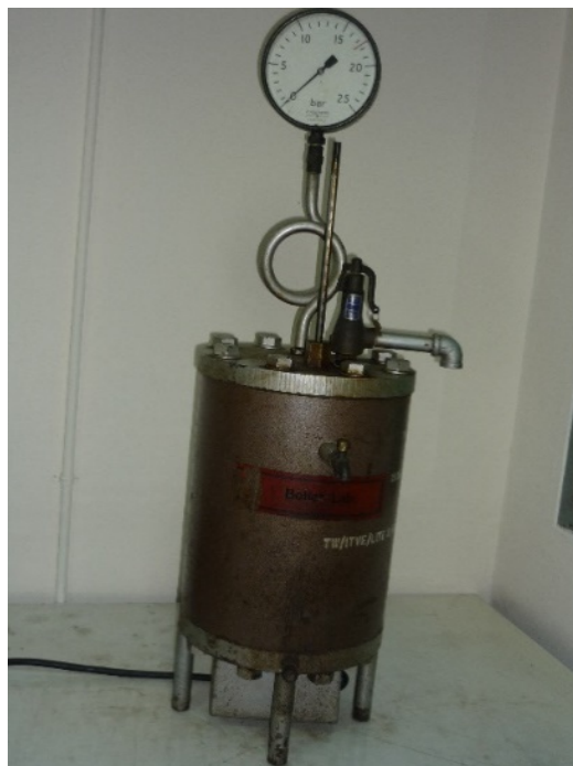
หัวข้อการทดลอง 1. หม้อไอน้ำมาร์เซ็ท 3.12 marcet boiler Set
