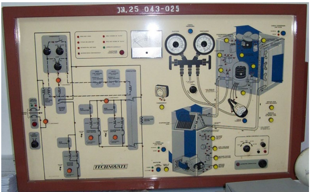
หัวข้อการทดลอง 1. ระบบการทำความเย็น 3.4 Refrigeration Unit
