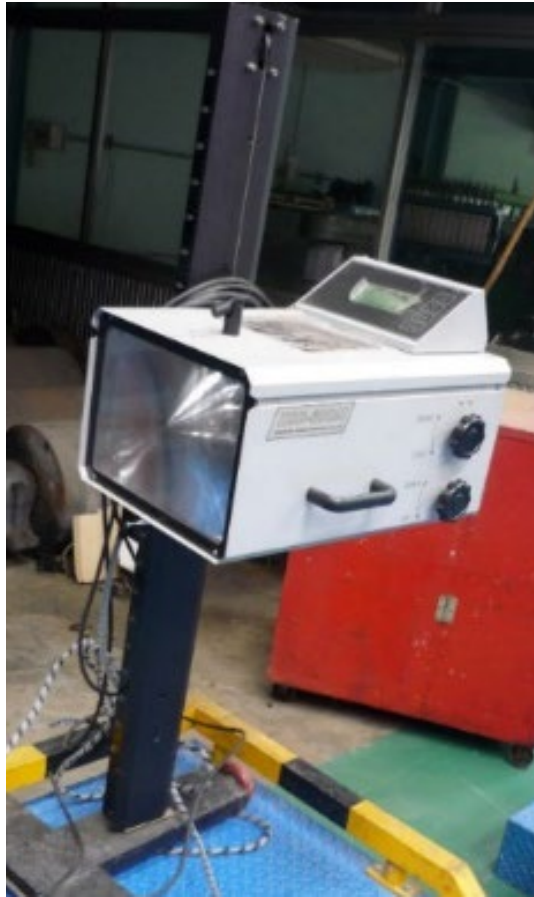
หัวข้อการทดลอง 1. การวัดความสูงของไฟหน้า 2.16 Headlight Tester Set
