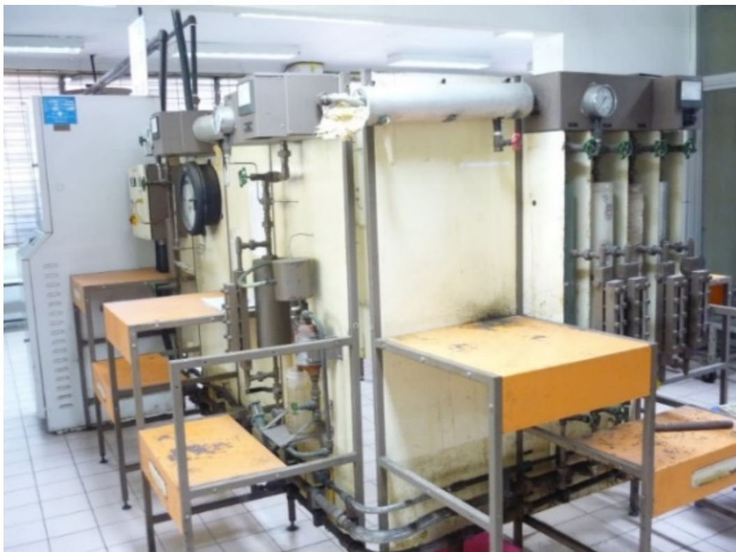
หัวข้อการทดลอง 1. การหาค่าความแห้งไอน้ำ 3.14 Steam Dryness Fraction Set
