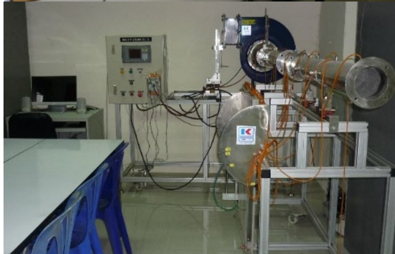
หัวข้อการทดลอง 1. การวัดการไหลของอากาศ 1.4 Air Flow Test Set
