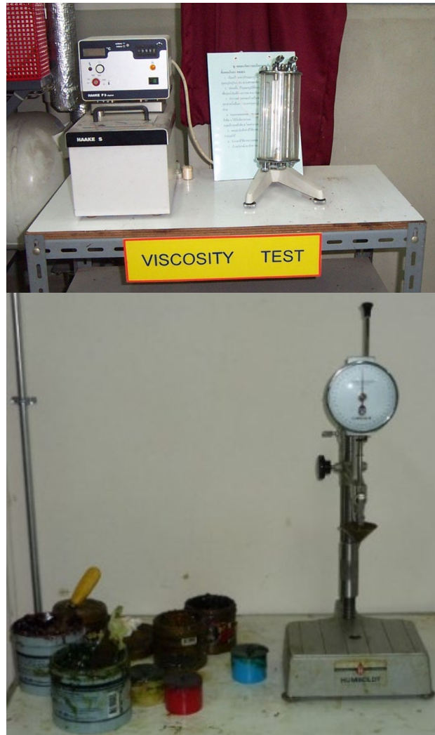
หัวข้อการทดลอง 1. ความหนืดของน้ำมัน 2. ความเหนียวชั้นของจาระบี 1.9 Vicosity Test Set
