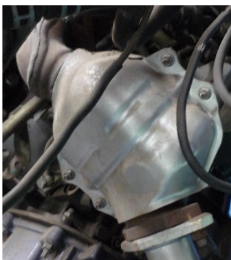
หัวข้อการทดลอง 1. การทำงานของอุปกรณ์แปรสภาพแก๊สไอเสีย 2.5 Exhaust Gas Catalytic Converter Set
