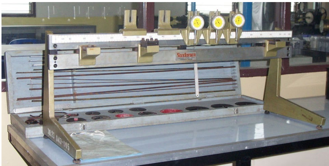
หัวข้อการทดลอง 1. การทดสอบการโก่งของคาน 5.6 Deflection of Beams Set
