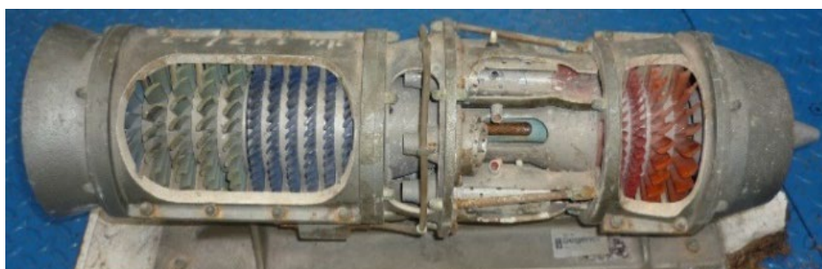
หัวข้อการทดลอง 1. ส่วนประกอบและการทำงานของเครื่องยนต์เจ็ท 2.15 Sectioned Jet Engine Set
