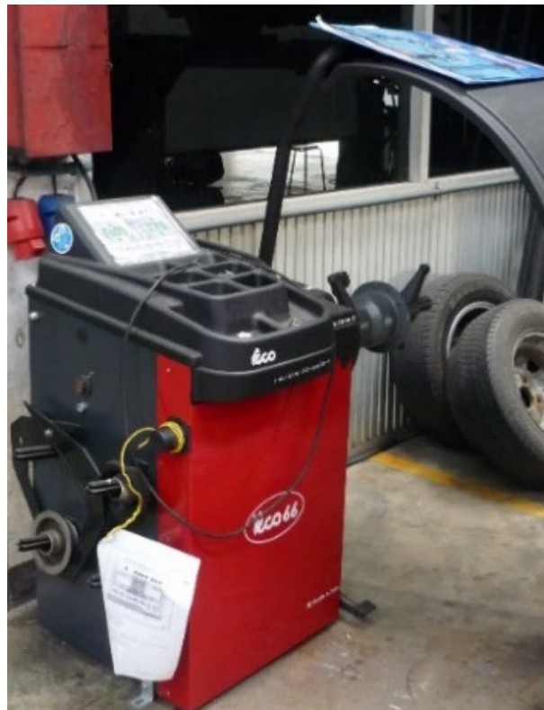
หัวข้อการทดลอง 1. การถ่วงล้อรถยนต์ 2.17 Wheel Balancer Set
