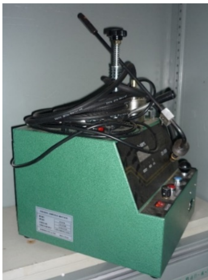
หัวข้อการทดลอง 1. การวัดควันดำ 2.3 Exhaust Gas Analyzer & Smoke Detector Set
