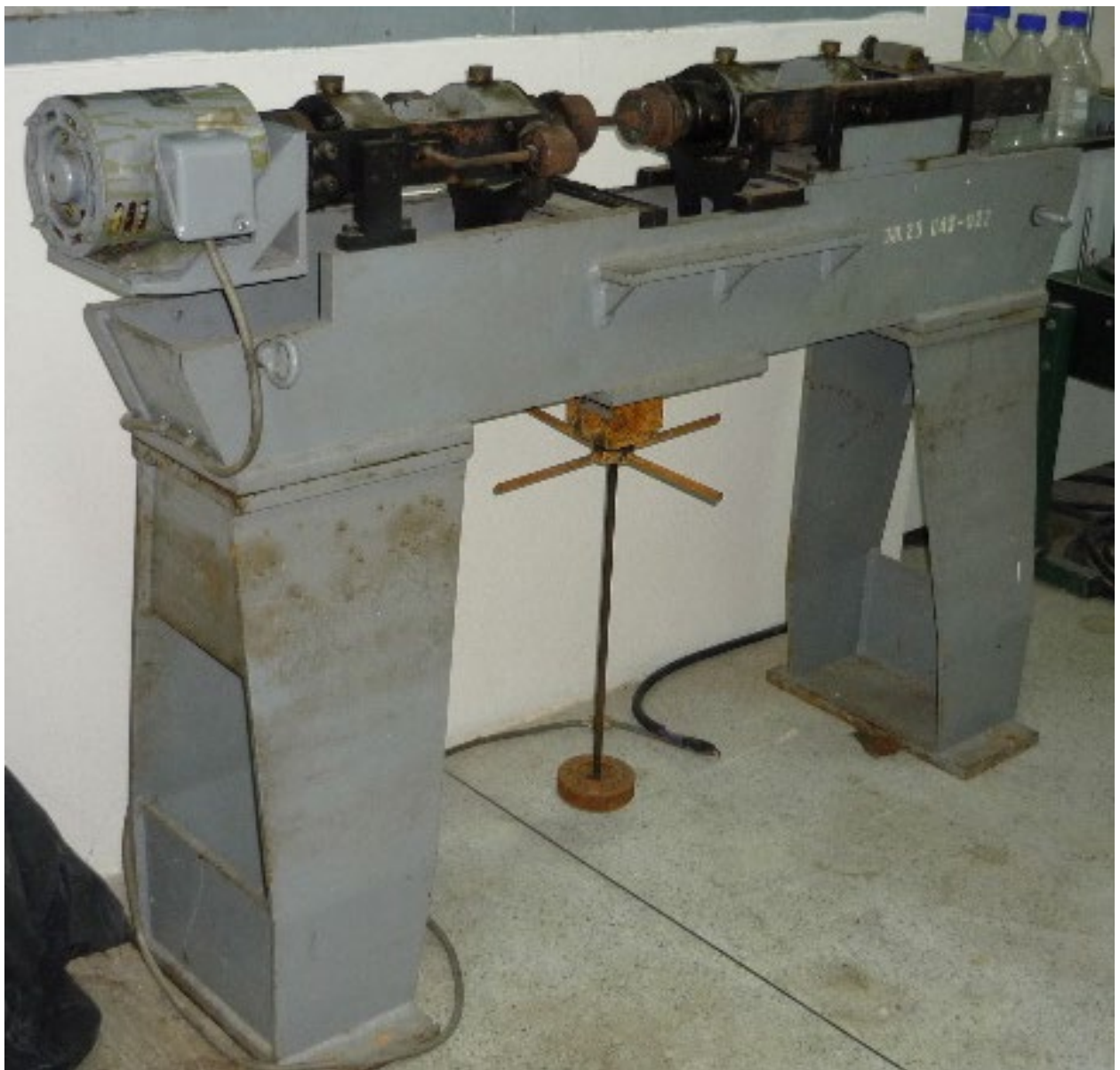
หัวข้อการทดลอง 1. การทดสอบความล้าของวัสดุ 5.4 Fatigue Test set
