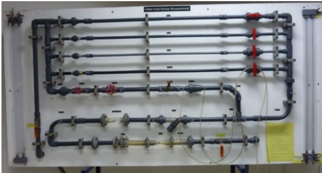
หัวข้อการทดลอง 1. การสูญเสียพลังงานในระบบท่อ 1.5 Flow or Fiction loss in Pipe Set
