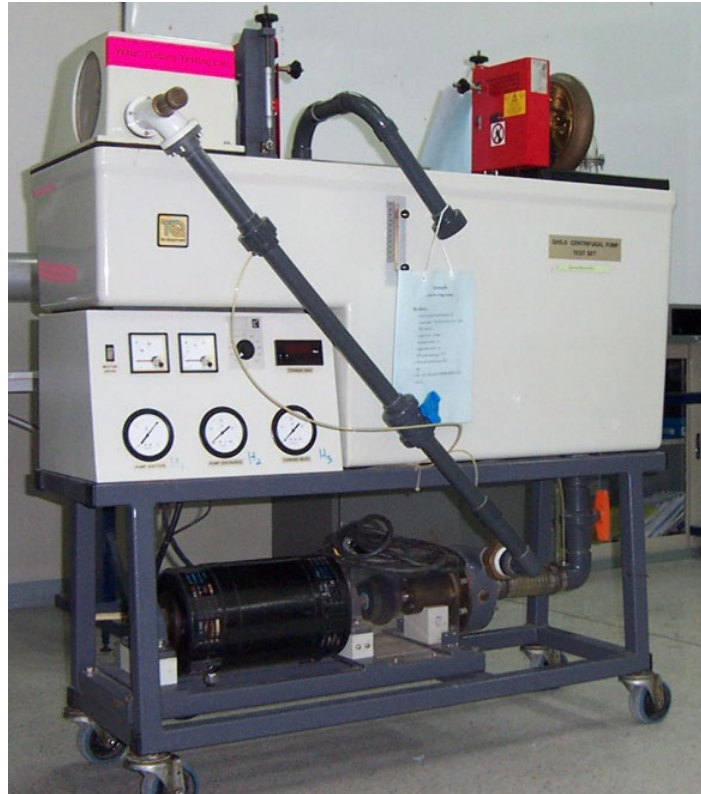
หัวข้อการทดลอง 1. การทดสอบกังหันเพลตัน 2. การทดสอบกังหันฟรานซิส 1.3 Pelton & Francis Turbine Test Set
