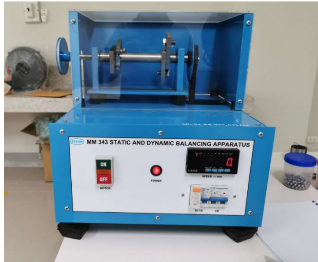
ปฏิบัติการที่ 15 สมดุลแบบสถิตและไดนามิก (Static and Dynamic Balancing Apparatus Test )
