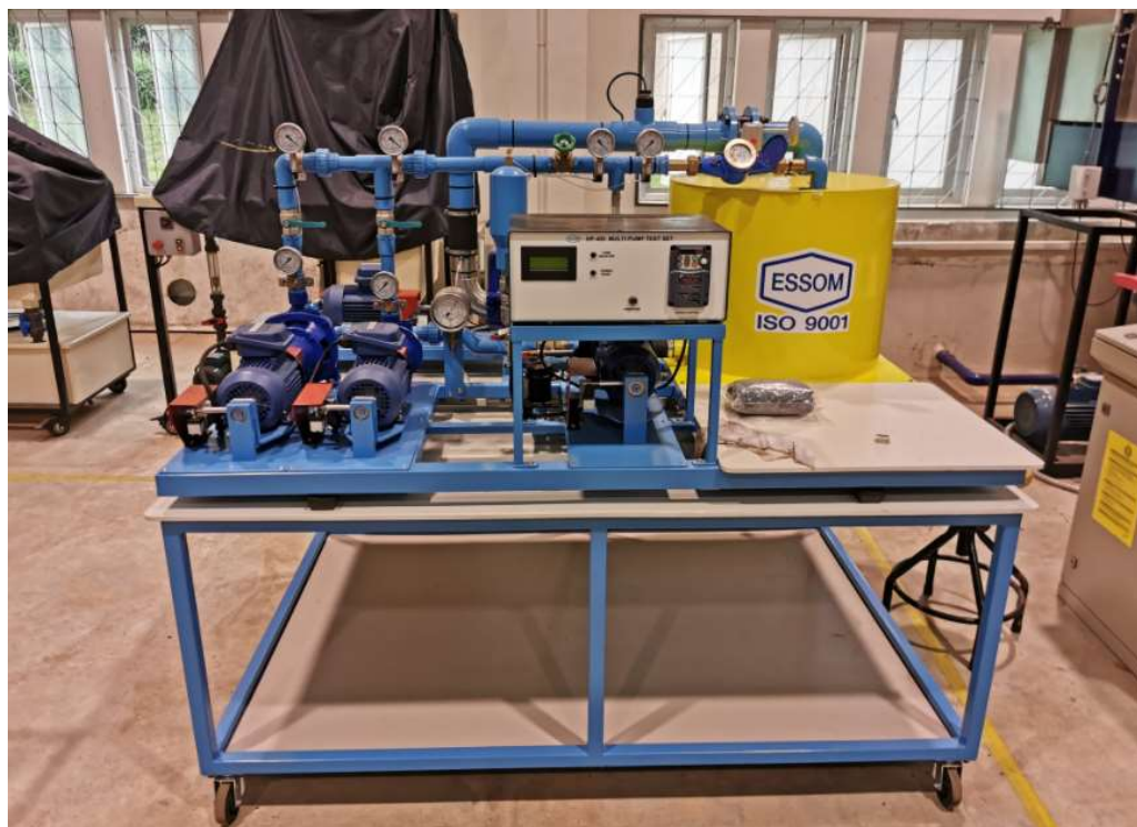
ปฏิบัติการที่ 16 เครื่องสูบน้ำแรงเหวี่ยงหนีศูนย์กลาง (Centrifugal Pump Test )
