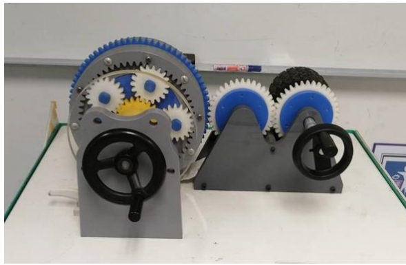
รูปที่ 15 ชุดสาธิตการทำงานชุดเฟืองแพลนเนตารี
