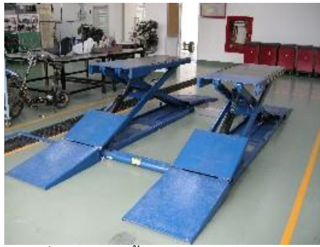
รูปที่ 3 ลิฟท์ X ชั้นเดียว สำหรับยกรถยนต์
