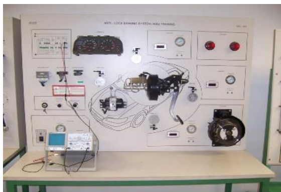
รูปที่ 5 ชุดปฏิบัติการ ANTI-LOCK Braking System
