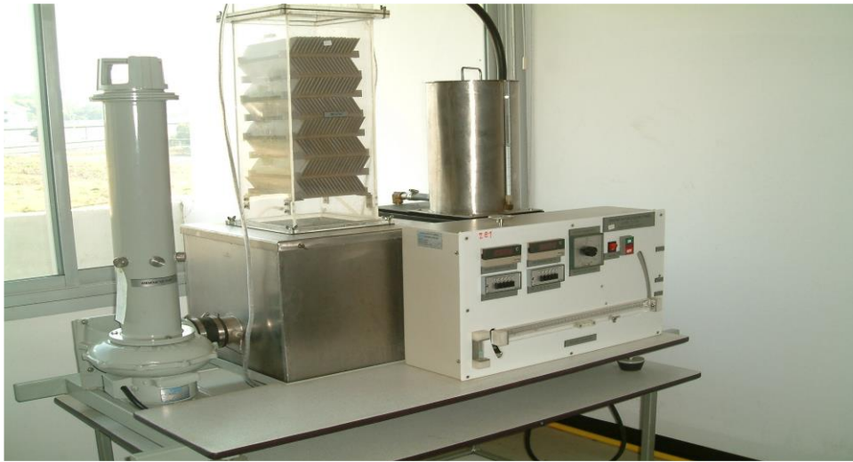
หมวด 3 ชุดปฏิบัติการที่ 5 “Demonstration Cooling Tower”
