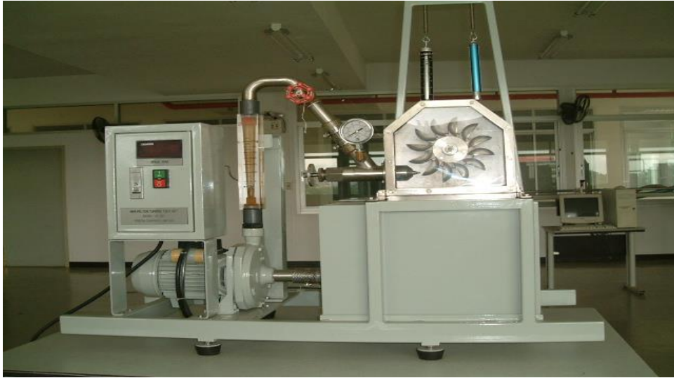
หมวด 1 ชุดปฏิบัติการที่ 2 “Compact Pelton Turbine Test Set”
