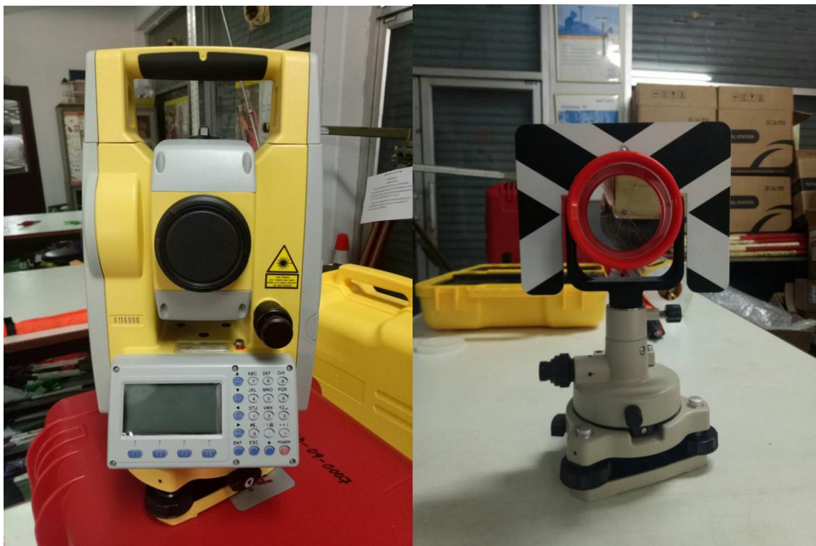
รูปที่ 1.2.6.3 กล้อง Total Station และ ปริซึม
