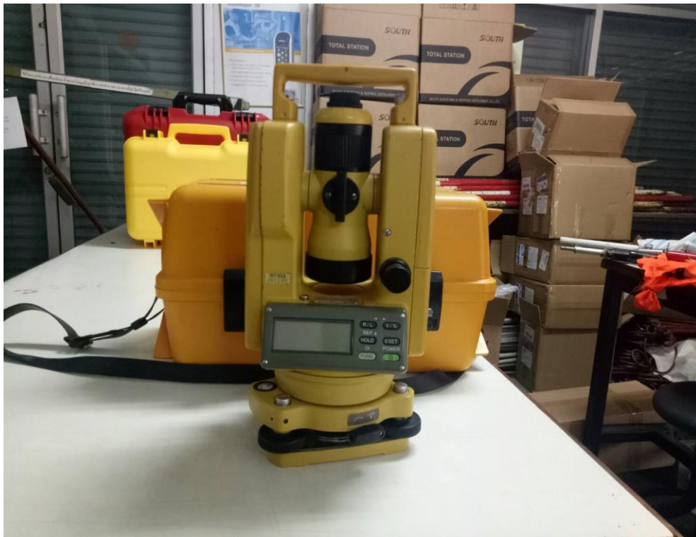
รูปที่ 1.2.6.2 กล้อง Theodolite
