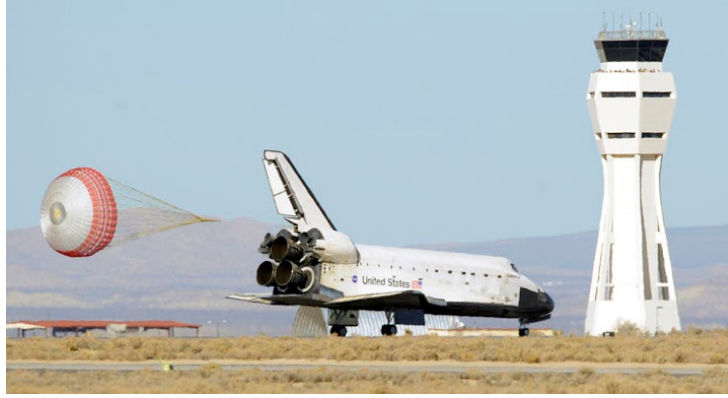
รูปที่ 12-1 การใช้ร่มชูชีพ ซึ่งใช้แรงเสียดทานในของไหลช่วยในการเบรกขณะลงจอดของกระสวยอวกาศ
