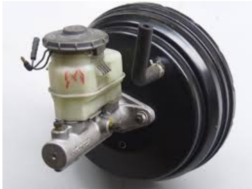
รูปที่ 12-5 แม่ปั้มเบรกและหม้อลมช่วยเพิ่มแรงเบรก
