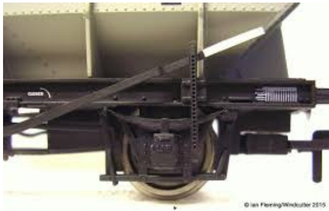
รูปที่ 12-6 เบรกกำมปูใช้เบรกล้อรถไฟ
