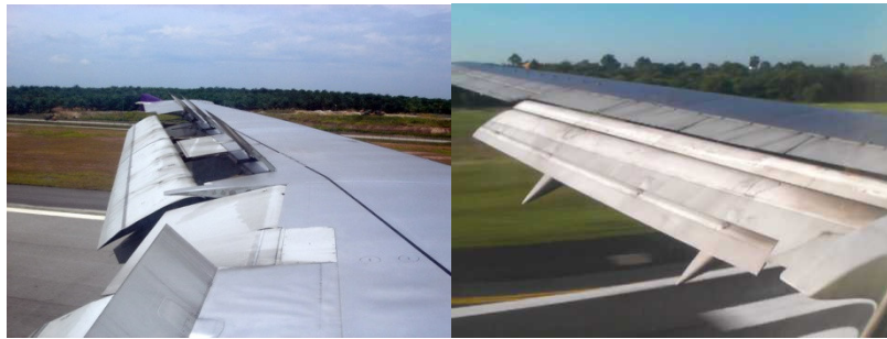
รูปที่ 12-2 การงอปลายปีกเครื่องบินลงไปในอากาศระหว่างจะลงจอดบนพื้นดิน เพื่อช่วยในการเบรกเครื่องบินหยุดเร็วขึ้น
