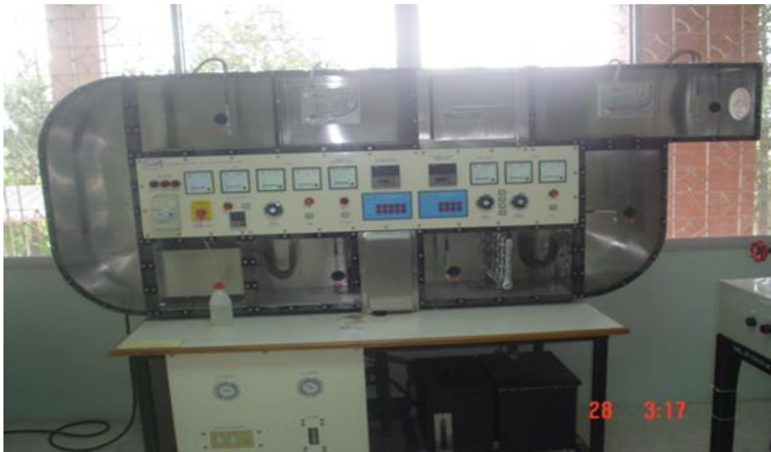
รูปที่ 6 Recirculating air conditioning unit
