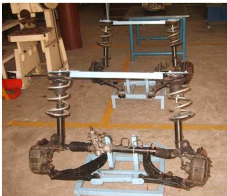
รูปที่ 9 ชุดระบบรองรับน้ำหนัก, ชุด Drum brake และชุด Disc brake
