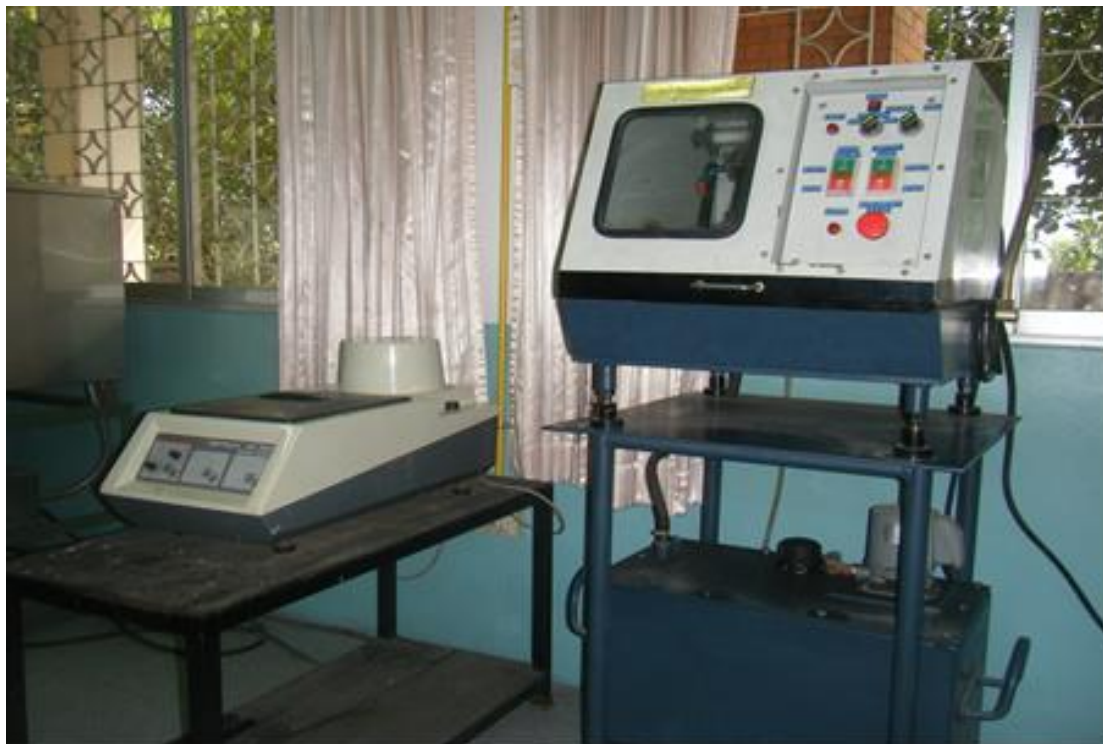
รูปที่ 1 เครื่องตัดชิ้นงานทดสอบ (Specimen cutting machine)
