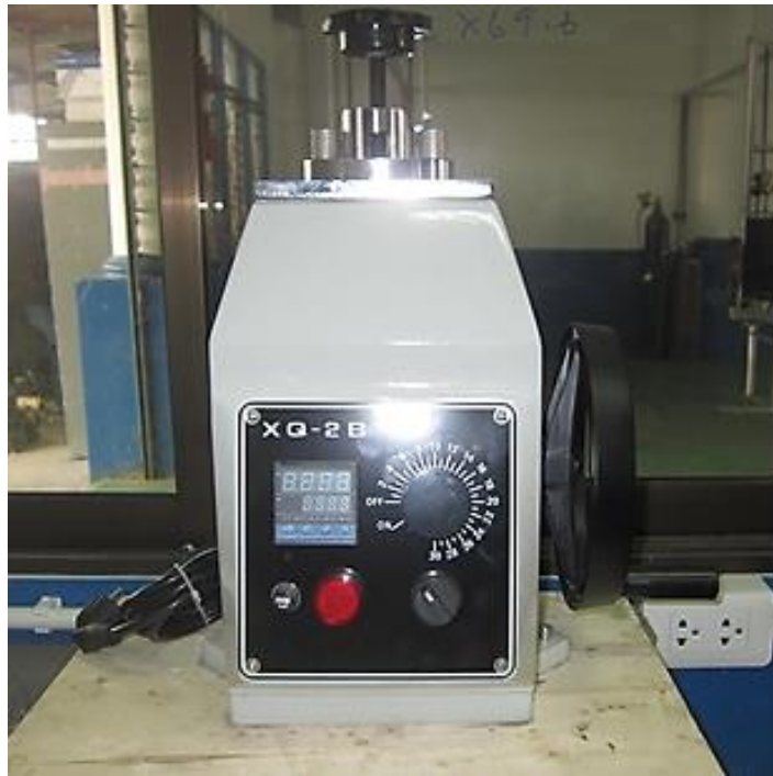
รูปที่ 2 เครื่องอัดขึ้นรูปตัวอย่างชิ้นงาน (Metallographic Compression Mounting)
