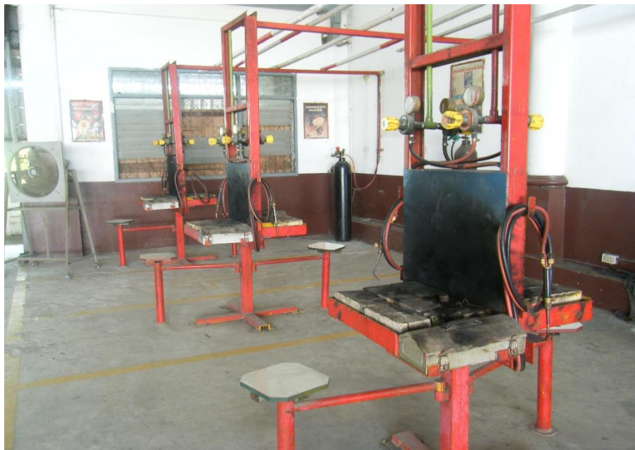
รูปที่ 9 ปฏิบัติการงานเชื่อมแก๊ส (Gas welding operations)
