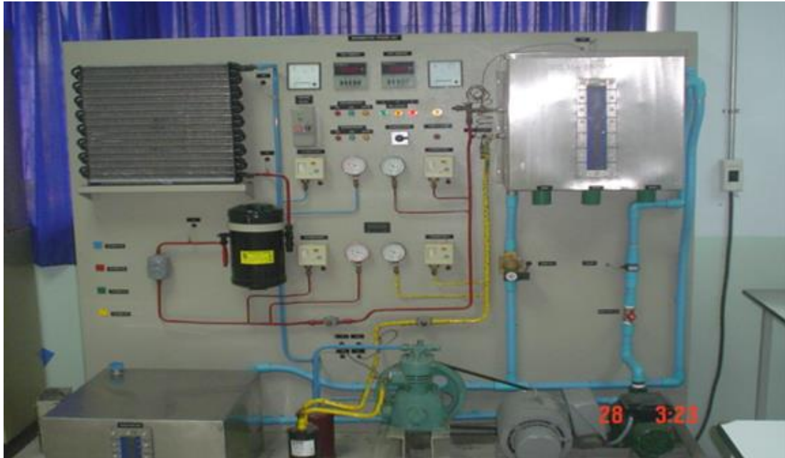
รูปที่ 5 Refrigeration training unit
