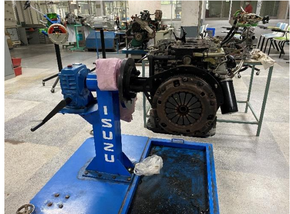
2. Diesel Engine Test Bed ห้อง 7105
