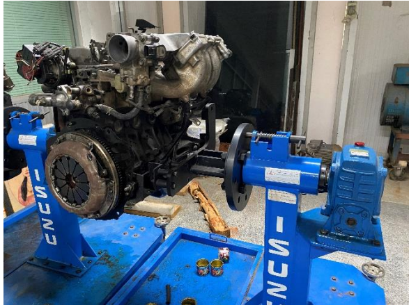
1. Gasoline Engine Test Bed ห้อง 7105
