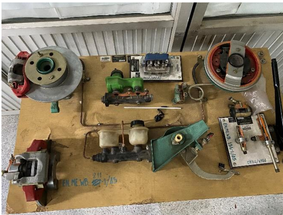
7. Working Hydraulic Disc/Drum Brake ห้อง 7105
