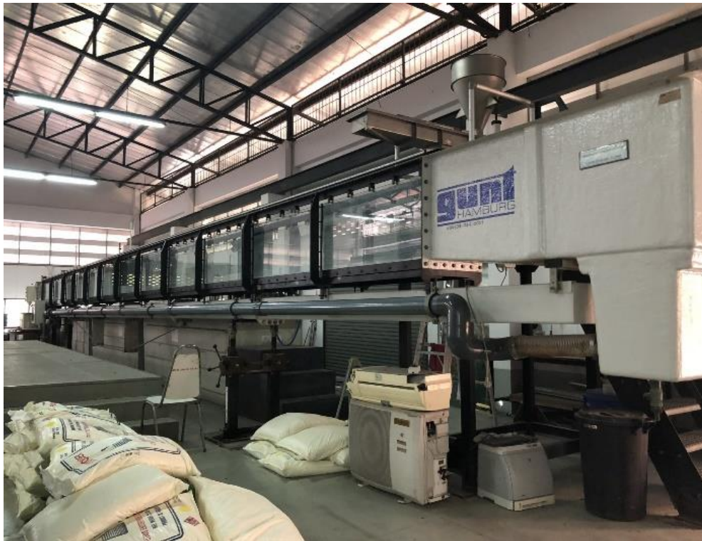
รูปที่ 1.2.2.16B ชุดอุปกรณ์การไหลผ่านประตูระบายน้ำ (flow through a sluice gate)
