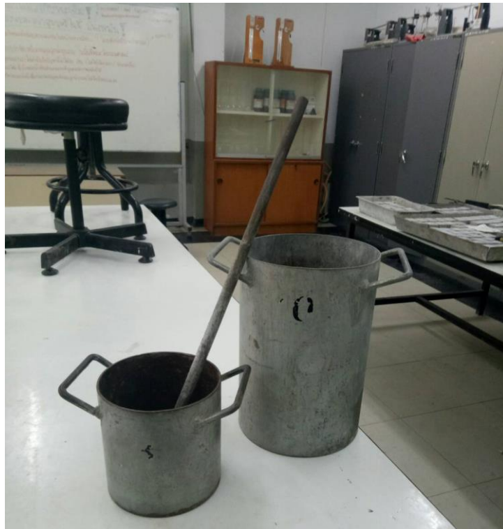
รูปที่ 1.2.4.7 ชุดทดสอบการหาค่าหน่วยน้ำหนักของคอนกรีต
