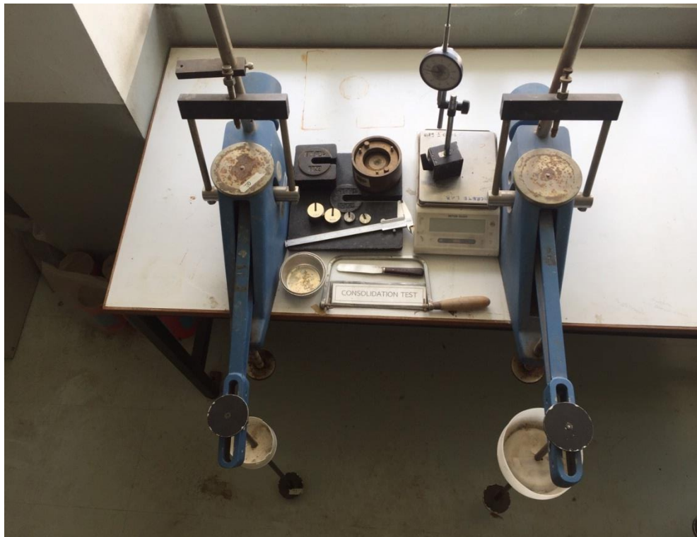
รูปที่ 1.2.1.11 ชุดทดสอบ Consolidation test
