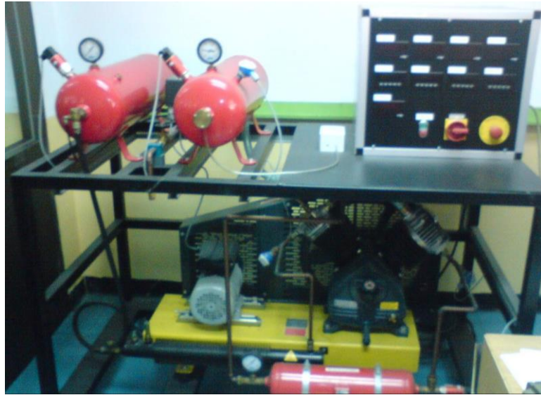
3.4 เครื่อง Two Stage Piston Compressor
