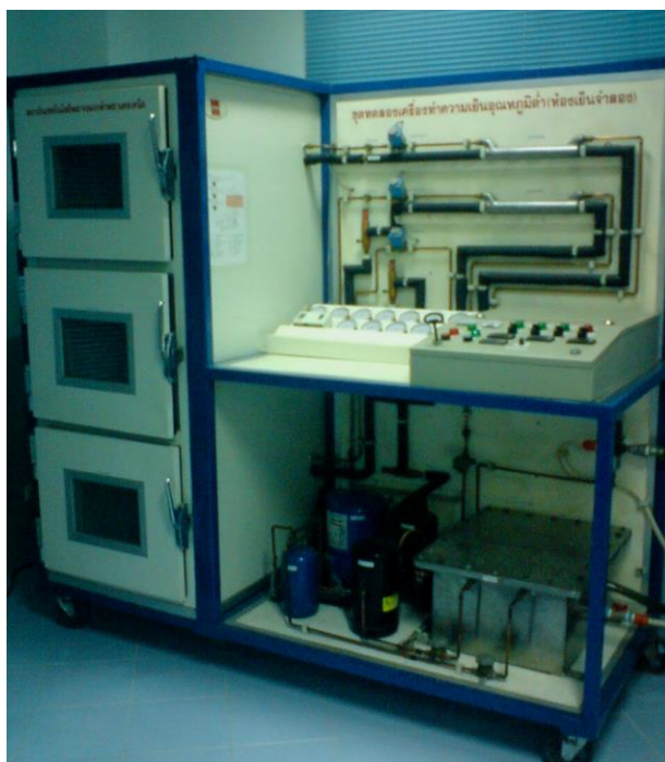
1.8 เครื่อง ชุดทดลองเครื่องทำความเย็นอุณหภูมิต่ำ (ห้องเย็นจำลอง)
