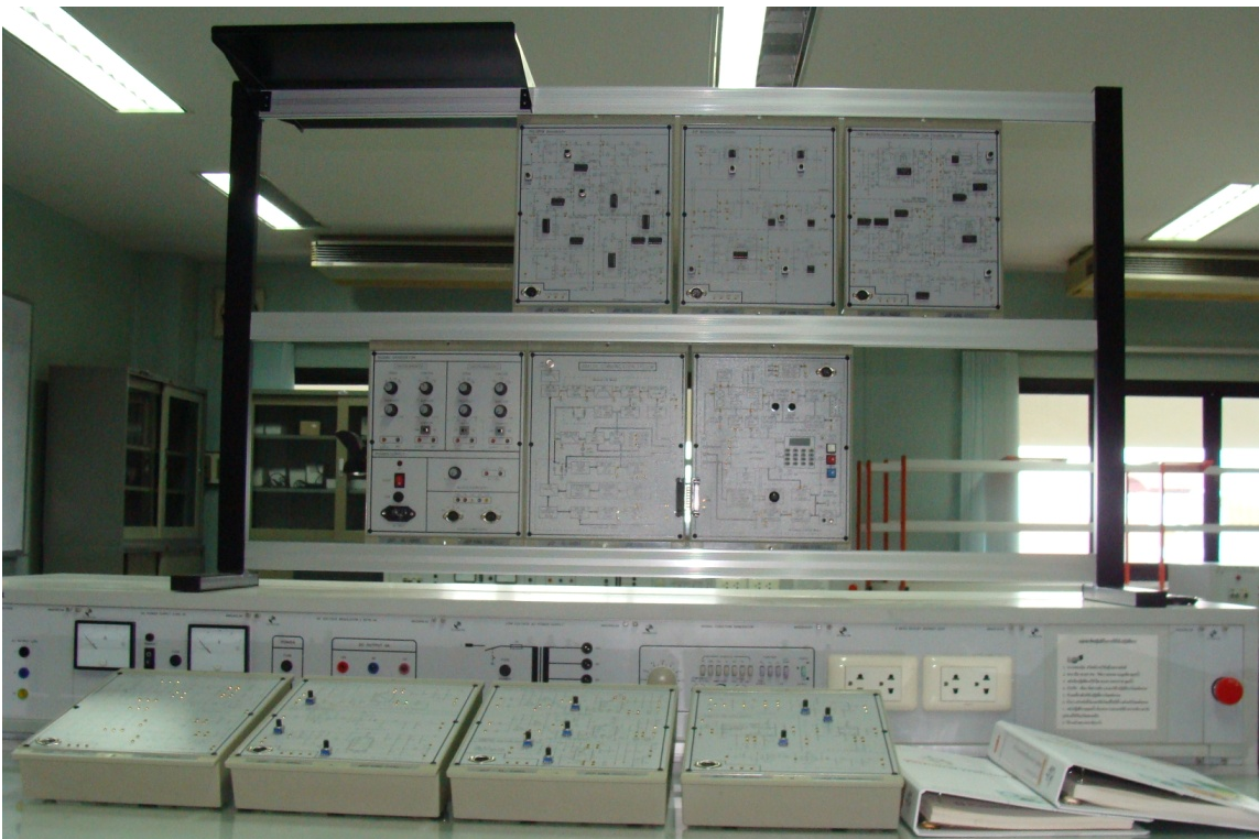
ชุดฝึกปฏิบัติการมอดูเลต/ดีมอดูเลต ในระบบแอนะล็อก
