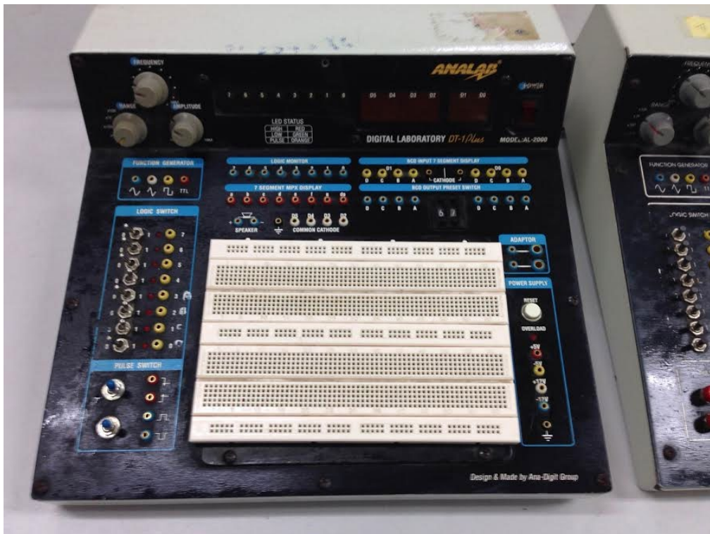
ชุดฝึกดิจิทัล ANALAB DT-1Plus
