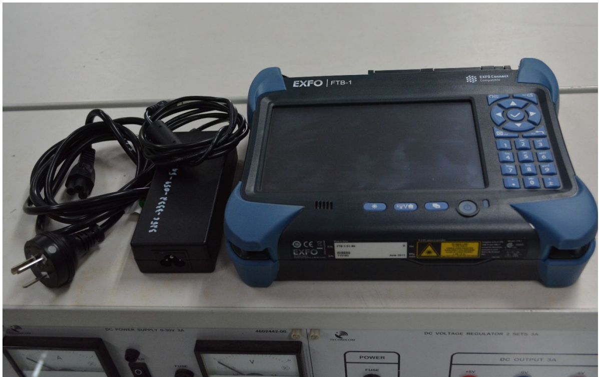
เครื่องวัดคุณสมบัติเส้นใยแก้วนำแสง EXFO FTB-1/FTB-720 (OTDR FTB 700 Series)
