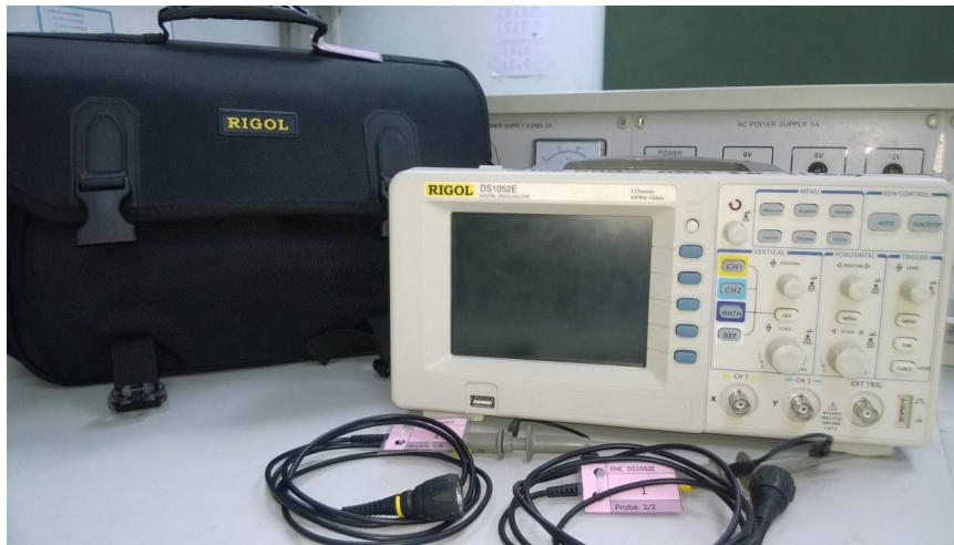
ออสซิลโลสโคป(RIGOL# DS1025E ; 50MHz)
