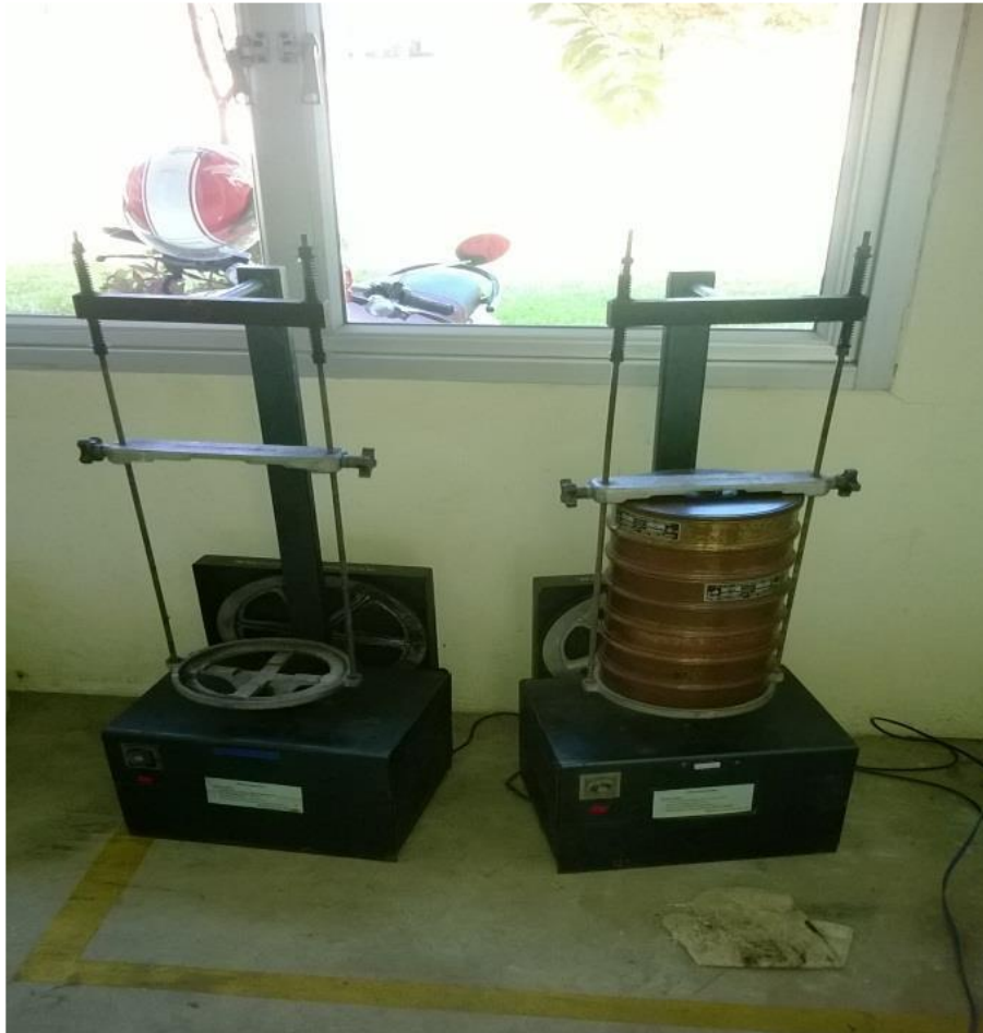
ชุดทดสอบหาขนาดของเม็ดดินโดยใช้ตะแกรงมาตรฐาน
