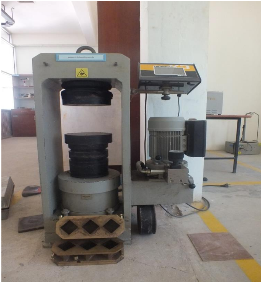
ชุดทดสอบกำลังอัดของแท่งซีเมนต์มอร์ต้า
