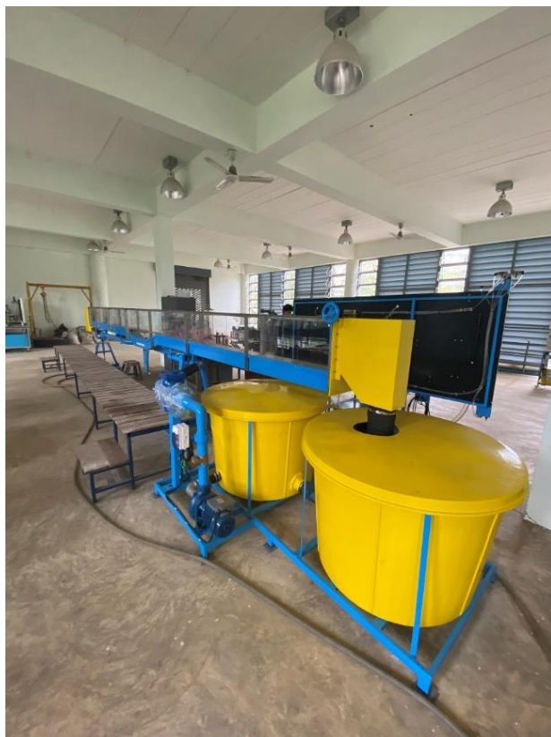
ชุดทดสอบการไหลตลอดประตุน้ำและไฮดรอลิกจัม
