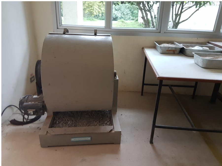
ชุดทดสอบการสีหรือของวัสดุมวลรวม
