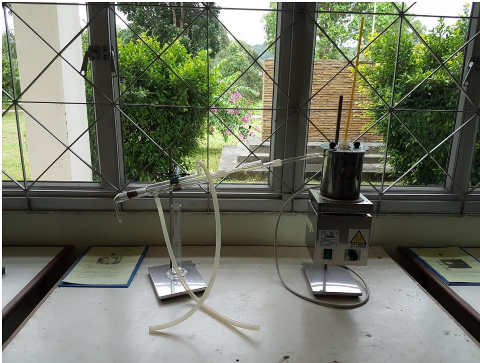
ชุดทดสอบการกลั่นผลิตภัณ์ซ์คัทแบคแอสฟัลต์
