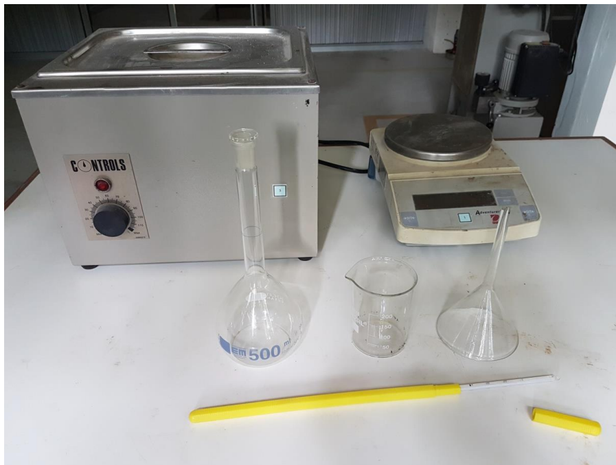
ชุดทดสอบหาค่าความถ่วงจำเพาะของซีเมนต์
