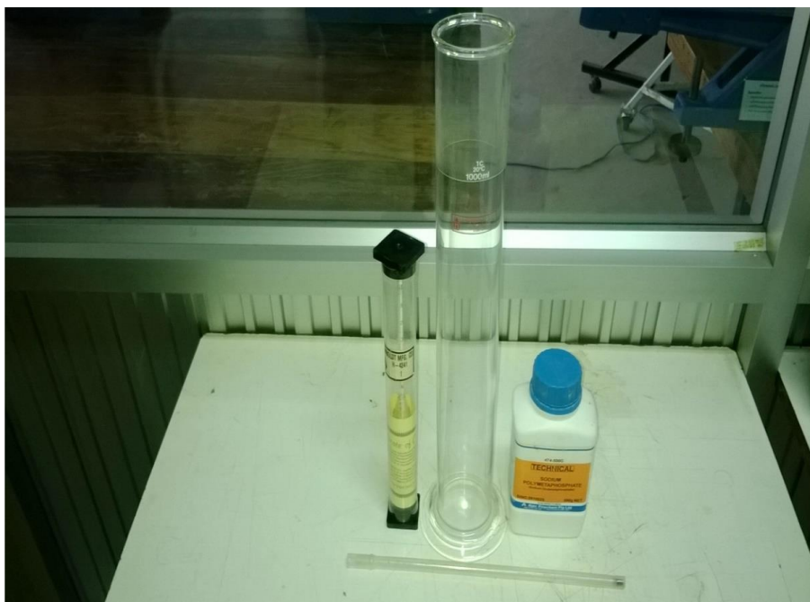
ชุดทดสอบหาขนาดเม็ดดินโดยไฮโดรมิเตอร์
