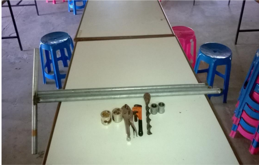
ชุดการเจาะสำรวจดิน (Soil investigation)
