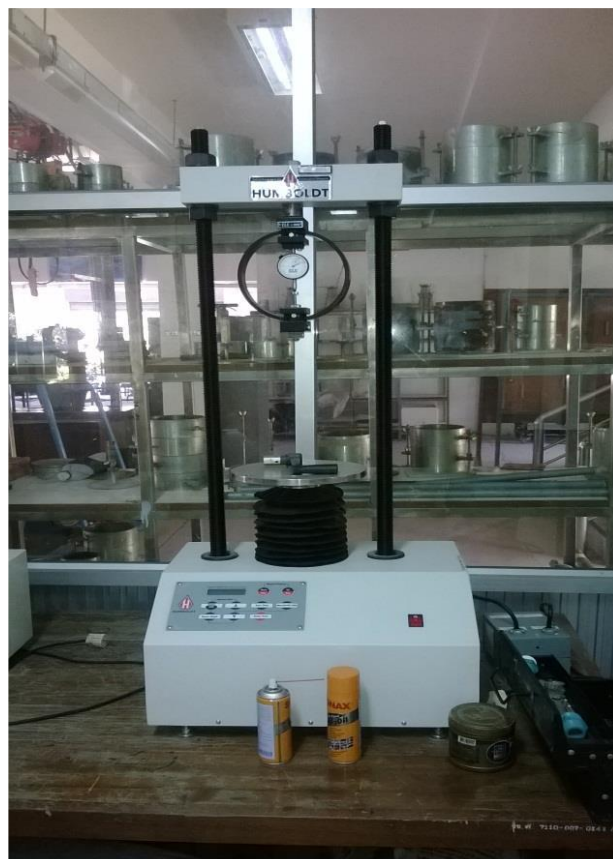
ชุดทดสอบแคลิฟอร์เนียแบริงเรโซ (C.B.R.)
