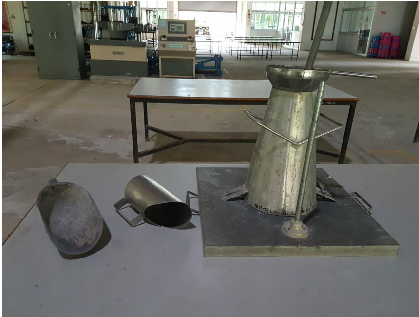
ชุดทดสอบการออกแบบส่วนผสมคอนกรีต
