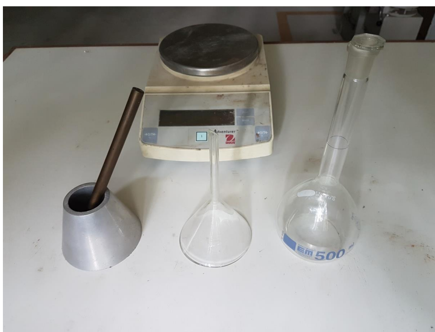
ชุดทดสอบหาค่าความถ่วงจำเพาะของวัสดุมวลรวมละเอียด
