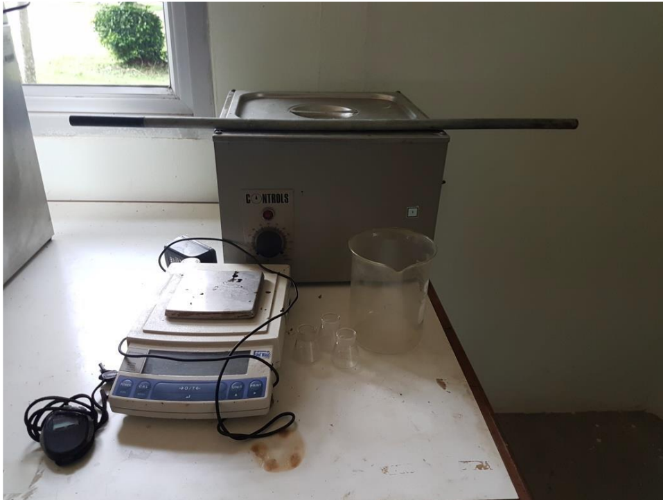
ชุดทดสอบความถ่วงจำเพาะและความหนาแน่นของวัสดุแอสฟัลต์
