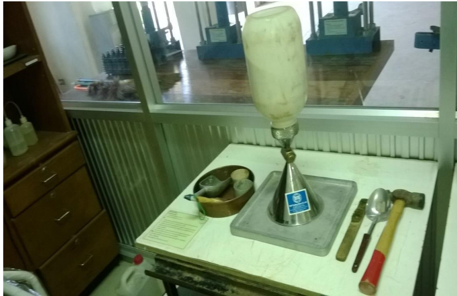
ชุดทดสอบหาค่าความหนาแน่นของดินในสนามโดยวิธีกรวยทราย
