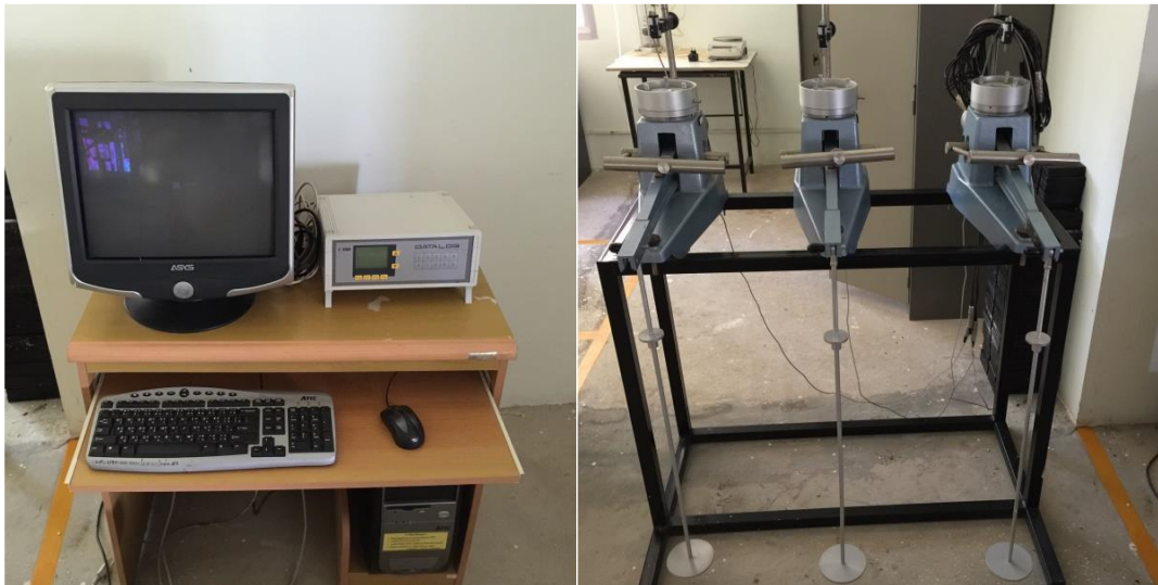
ชุดทดสอบ Consolidation Test
