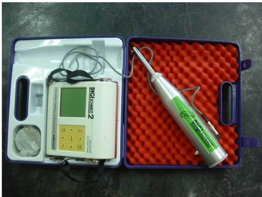
เครื่องทดสอบแบบไม่ทำลาย Digi Schmidt Hammer
