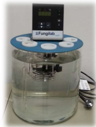
ชุดทดสอบ ความเหนียวแบบเซย์โบลฟูโรล
