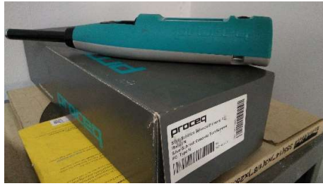
ชุดการทดลอง หาค่ากำลังรับแรงอัดของคอนกรีตทางอ้อมด้วยเครื่อง Schmidt hammer
