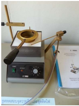
ชุดทดสอบ จุดความไฟและจุดติดไฟ
