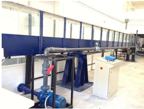
ชุดทดสอบ การไหลในทางน้ำเปิด
