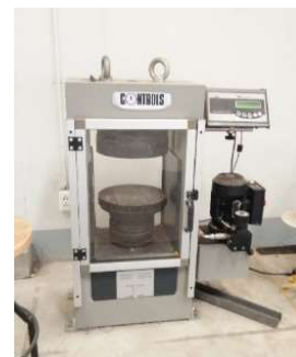
เครื่องกดคอนกรีต 150 ตัน
