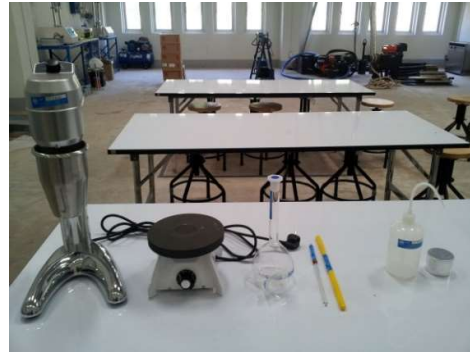
ชุดการทดลอง การทดสอบหาค่าความถ่วงจำเพาะของดิน
