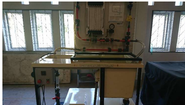
ชุดทดสอบ แรงดันสถิตย์ของของไหลต่อพื้นผิววัตถุที่จมในของไหล
