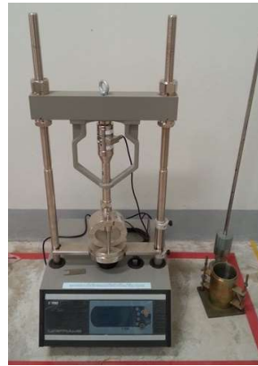
ชุดทดสอบ อัสฟัลท์คอนกรีตมิกซ์โดยวิธีมาร์แชล
