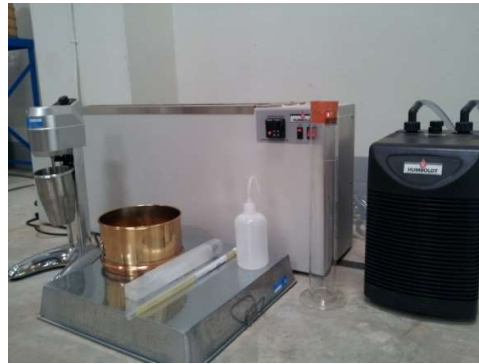
ชุดการทดลอง หานขนาดเม็ดดินด้วยตะแกรงร่อน(Sieve Analysis) และวิธีตกตะกอน (Hydrometer Analysis)
