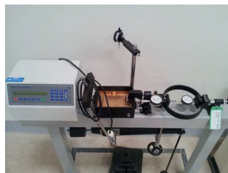
ชุดการทดลอง แรงเฉือนตรง
