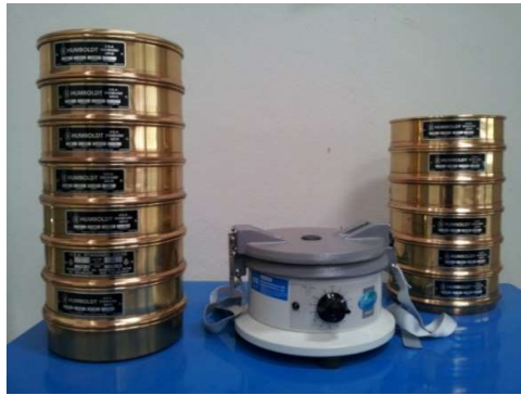
ชุดการทดลอง หานขนาดเม็ดดินด้วยตะแกรงร่อน(Sieve Analysis) และวิธีตกตะกอน (Hydrometer Analysis)
