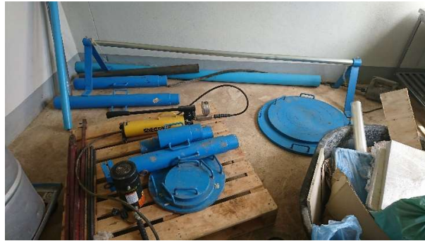
ชุดการทดลอง แรงแบกทานของดิน (Plate bearing Test)
