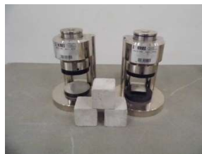
ชุดทดสอบกำลังรับแรงอัดมอร์ต้า
