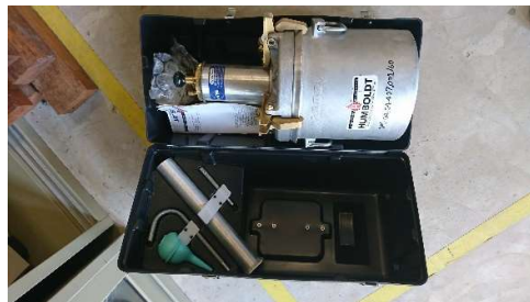
ชุดการทดลอง หาค่าปริมาณอากาศในคอนกรีต
