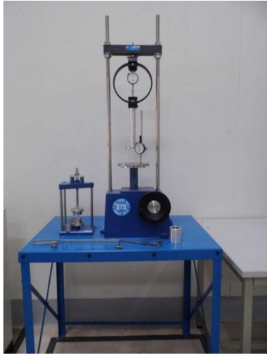
ชุดการทดลอง แรงอัดแบบไม่ถูกจำกัด
