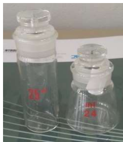
ชุดทดสอบ ความถ่วงจำเพาะของวัสดุพิวเมนโดยใช้ขวด ถ.พ.
