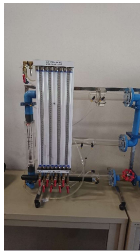
ชุดทดสอบ การวัดอัตราการไหลด้วย ventury channel
