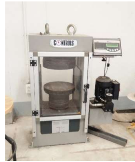
เครื่องทดสอบแรงกดขนาด 150 ตัน
