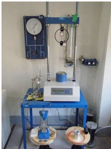
ชุดการทดลอง แรงอัดสามแกน (Triaxial Test)
