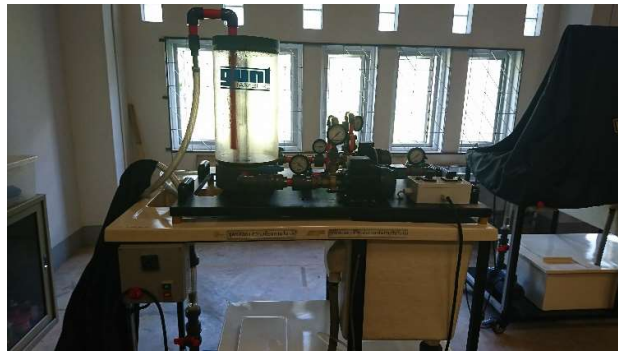
ชุดทดสอบ การหาค่าความดันสูญเสียในท่อและอุปกรณ์ในระบบท่อ
