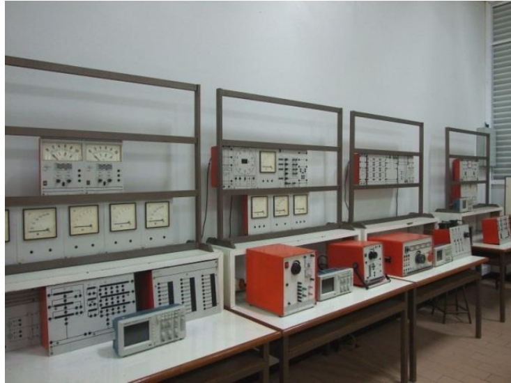
ชุดทดลองปฏิบัติป้องกันระบบไฟฟ้ากำลัง
