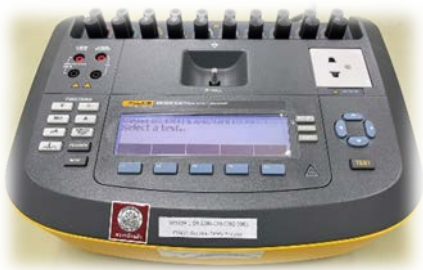
เครื่องวัดความผิดปกติทางไฟฟ้า ยี่ห้อ FLUKE รุ่น ESA620
