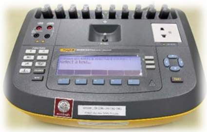
เครื่องวัดความปลอดภัยทางไฟฟ้า ยี่ห้อ FLUKE รุ่น ESA620
