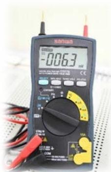
เครื่องดิจิตอลมัลติมิเตอร์ ยี่ห้อ Sanwa รุ่น CD772
