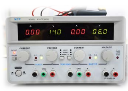
แหล่งจ่ายไฟฟ้ากระแสตรง ยี่ห้อ MCP รุ่น M10-TP3005H
