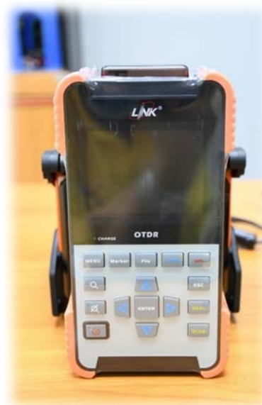
เครื่องวัด OTDR ยี่ห้อ LINK รุ่น UF-2872
