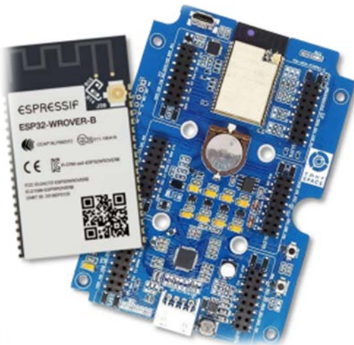
บอร์ดไมโครคอนโทรลเลอร์ Espressif ESP32 Dual-Core Tensilica LX6 240 MHz 32-bit
