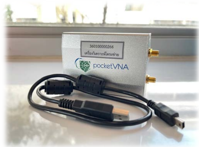
เครื่องวิเคราะห์โครงข่าย ยี่ห้อ PocketVNA รุ่น Hardware Version 4 GHz
