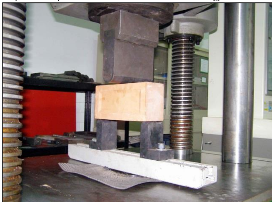
อุปกรณ์ชุดทดสอบการรับแรงตัดของอิฐก่อสร้าง
