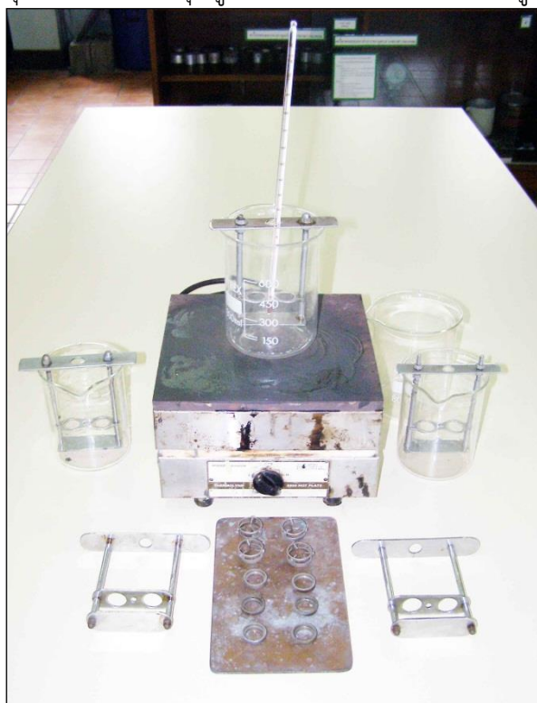
ชุดการทดสอบจุดอ่อนตัวของวัสดุปิทูเมน โดยใช้เครื่องวงแหวนกับลูกเหล็กมาตรฐาน
