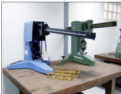
เครื่องหาความต้านทานแรงดึงและแรงอัดของ ซีเมนต์มอตาร์ (Briquet Machine)
