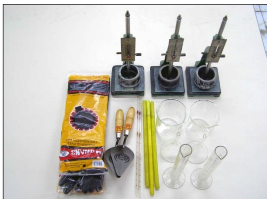
เครื่องหาความชื้นเหลวปกติและระยะเวลา ก่อตัวของซีเมนต์โดยใช้เข็มไวแคต
