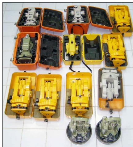
กล้องระดับ เลเซอร์, เลเซอร์ปิม และรีโอดไลท์
