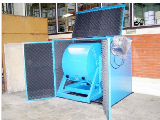
เครื่องมือหาความต้านทานการขัดสี ของหิน (Losangeles Abrasion)
