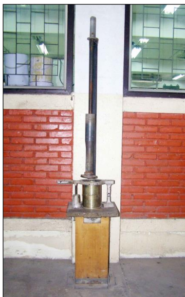
เครื่องบดอัดส่วนผสมแอสฟัลต์คอนกรีต
