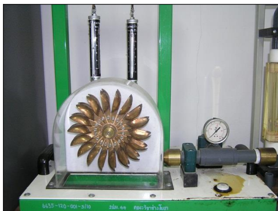
ชุดการทดสอบกังหันน้ำแบบเพลตัน
