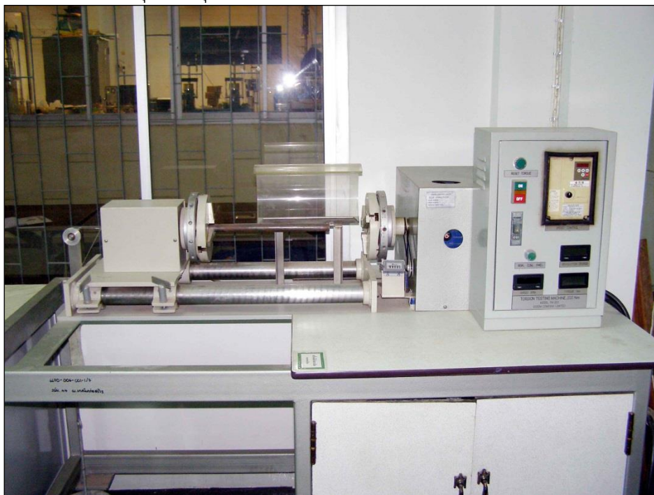
อุปกรณ์ชุดทดสอบการรับแรงเฉือนด้วยการบิดของเหล็ก
