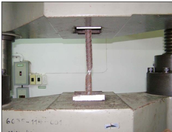
อุปกรณ์ชุดทดสอบการรับแรงดึงของเหล็กเสริมคอนกรีต
