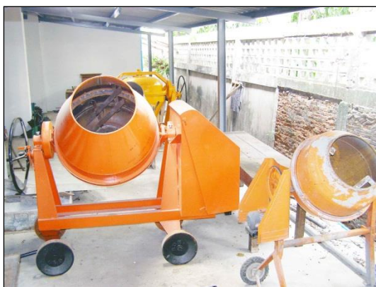
เครื่องผสมคอนกรีต (Mix Design)
