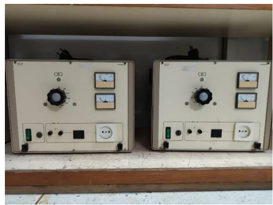
ชุดแหล่งจ่ายแรงดันไฟฟ้ากระแสสลับปรับค่าได้
