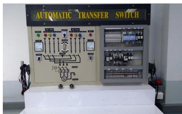
ชุดทดลองระบบ Auto Transfer Switch
