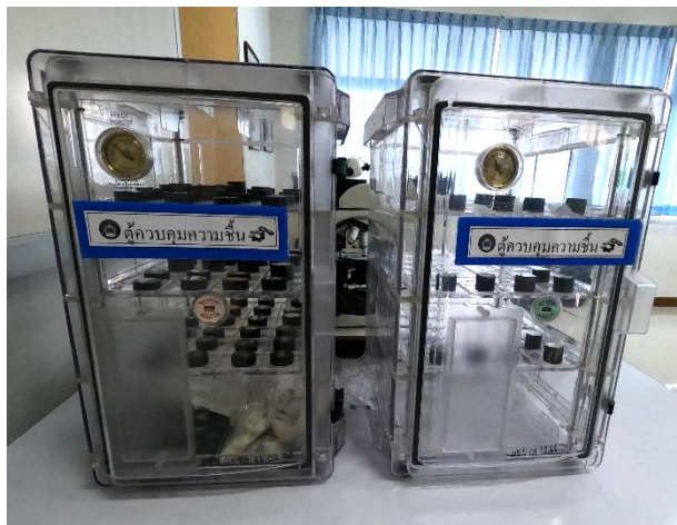
1.4 ตู้ควบคุมความชื้น
