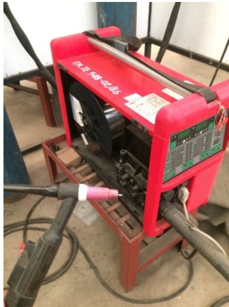
เครื่องเชื่อม MIG (Metal inert gas)
