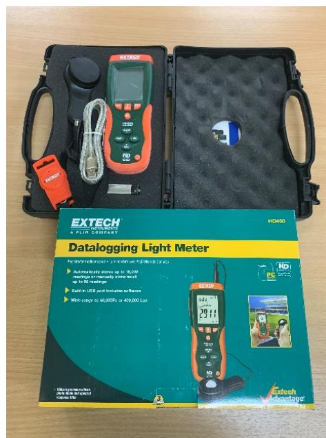
ภาพที่ 23 เครื่องวัดระดับความเข้มแสง (Light meter)
