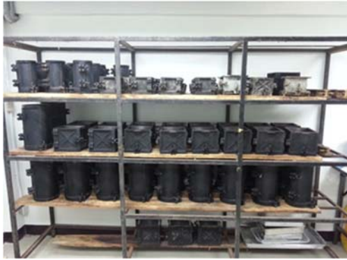
แบบหล่อมอร์ตาร์ทรงลูกบาศก์ ขนาด 5x5x5 ซม. แบบหล่อ คอนกรีตทรงลูกบาศก์ขนาด 15x15x15 ซม. และ ทรงกระบอกขนาด \varnothing 15x30 ซม.
