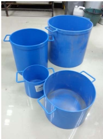
ชุดทดสอบการหาค่าหน่วยน้ำหนักของคอนกรีต
