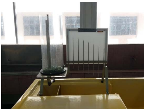
ชุดทดลองการไหลผ่านรูระบายน้ำตัดกลม
