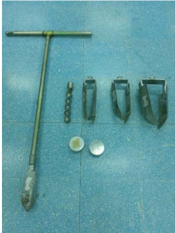
เครื่องเจาะสำรวจชั้นดิน
