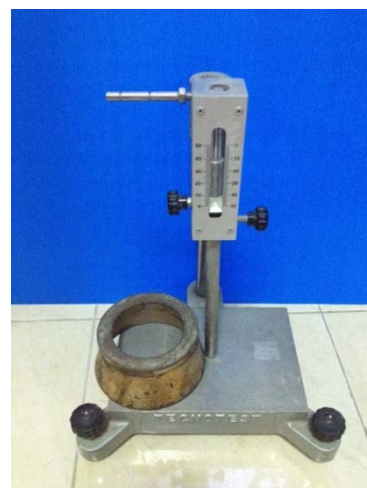
ชุดทดสอบความชื้นเหลวปกติ และระยะการก่อตัวของซีเมนต์เพสต์ โดยใช้เข็มแบบไวแคต
