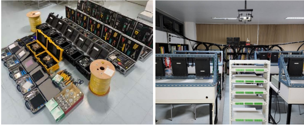
รูปที่ 50 ชุดฝึกปฏิบัติการ ติดตั้งโครงข่ายใยแก้วนำแสงตอนใน
