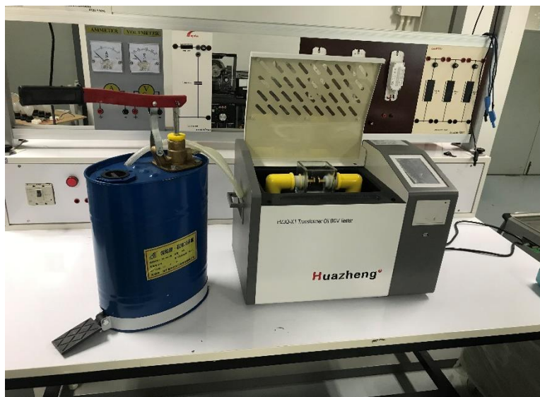
รูปที่ 30 ชุดทดสอบเบรกความถี่ในฉนวนเหลว
