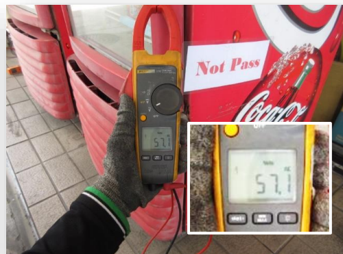
ตรวจเช็คด้วย Digital Multimeter พบว่ามีไฟรั่ว อยู่ที่ 57.1 Volt (AC)
