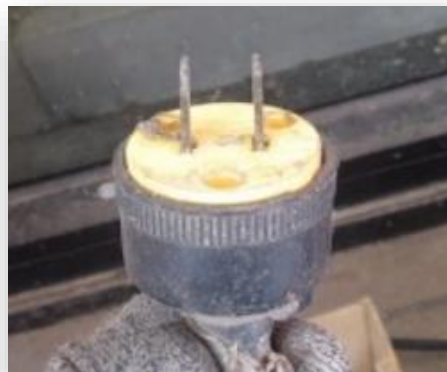
ตรวจเช็คด้วย Digital Multimeter พบว่ามีไฟรั่ว อยู่ที่ 57.1 Volt (AC)
