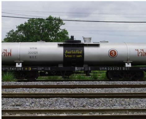
รถโบกี้บรรทุกน้ำมันค่น (บพค.) ขนส่งน้ำมันสำเร็จรูป
