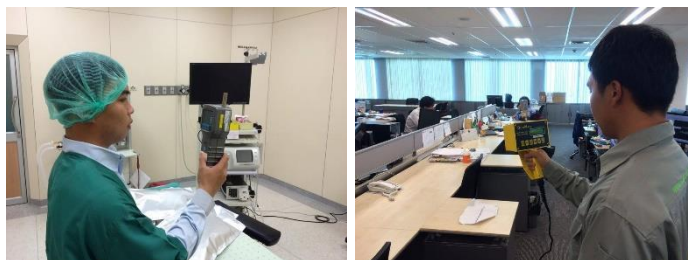
รูปที่ 93 การใช้เครื่องตรวจวัดคุณภาพอากาศในอาคาร
