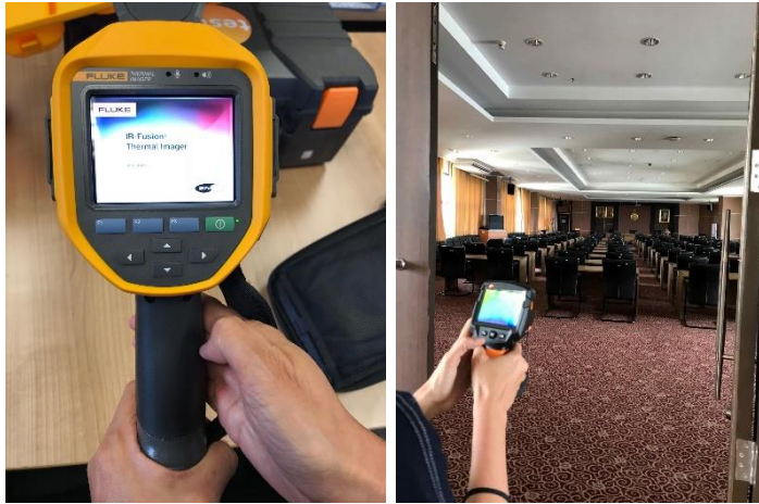
รูปที่ 4 กล้องถ่ายภาพความร้อน ยี่ห้อ FLUKE รุ่น Ti450 IR fusion technology
