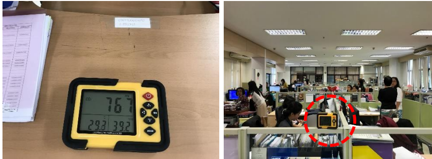
รูปที่ 6 เครื่องวัดคาร์บอนไดออกไซด์ CO 2 /Temp/RH data logger ยี่ห้อ HTI รุ่น HT-2000
