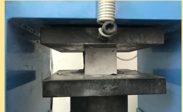
ภาพการทดสอบกำลังอัดของก้อนปูน
