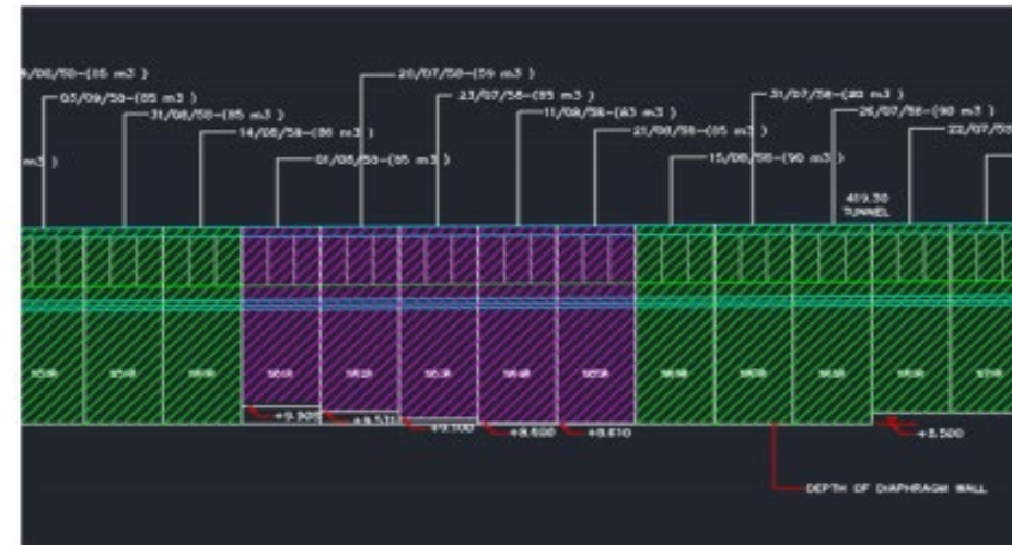
รูปถ่ายที่ 1-6 แสดงแบบผนังทึด ( DIAPHRAGM WALL ) ที่จุดเจาะไม่ถึงระดับที่ออกแบบไว้
