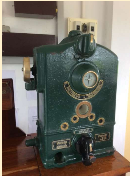
ระบบเครื่องทางสะดวก
