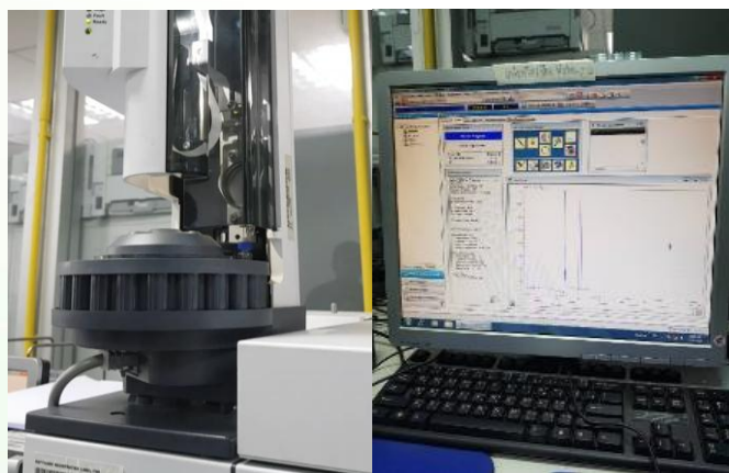
เครื่องมือวิเคราะห์ปริมาณและองค์ประกอบของเชื้อเพลิงเหลว (Distillation Gas Chromatography; DGC)
