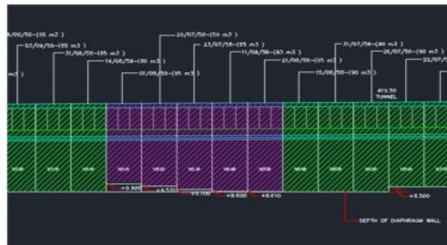
รูปภาพที่ 1-6 แสดงแบบผนังพิค ( DIAPHRAGM WALL ) ที่ขุดเจาะไม่ถึงระดับที่ออกแบบไว้
