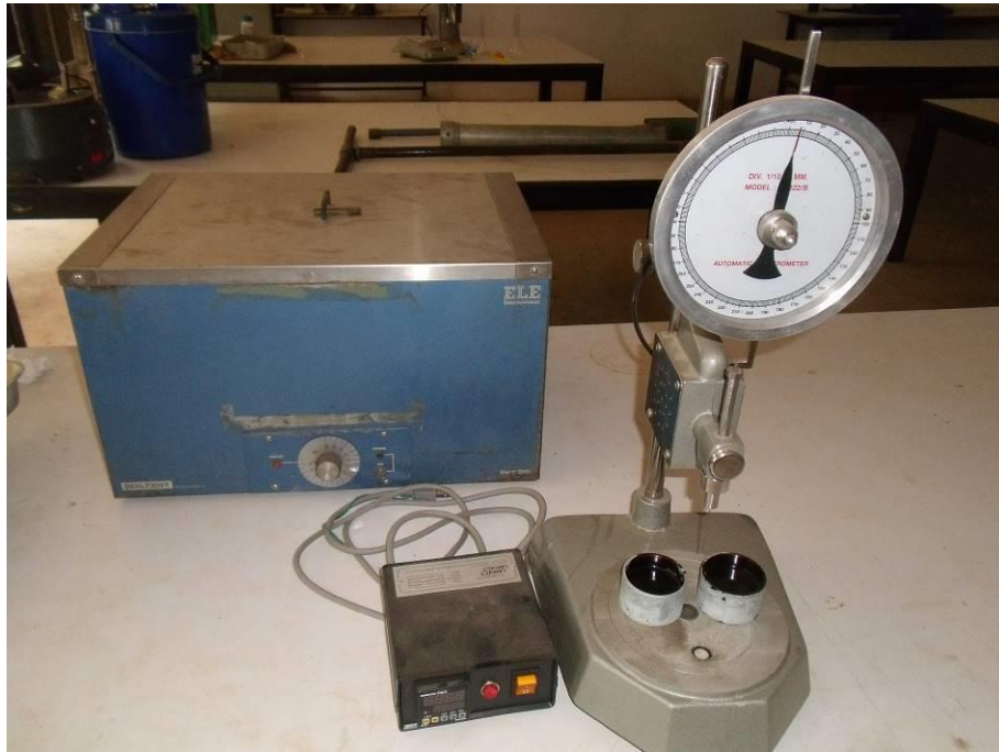
อุปกรณ์สำหรับการทดสอบเพนแทรกชันของวัสดุพิวเมน
