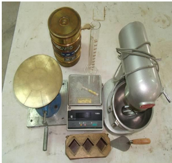
อุปกรณ์สำหรับการทดสอบกำลังรับแรงอัดของซีเมนต์มอร์ต้า
