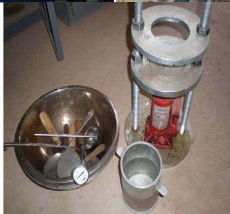
อุปกรณ์การทดสอบความต้านทานการไหลโดยวิธีมาแชลล์
