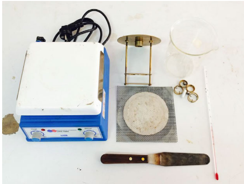
การทดสอบจุดอ่อนตัวของวัสดุบิทูเมนโดยใช้เครื่องวงแหวนกับลูกปืน
