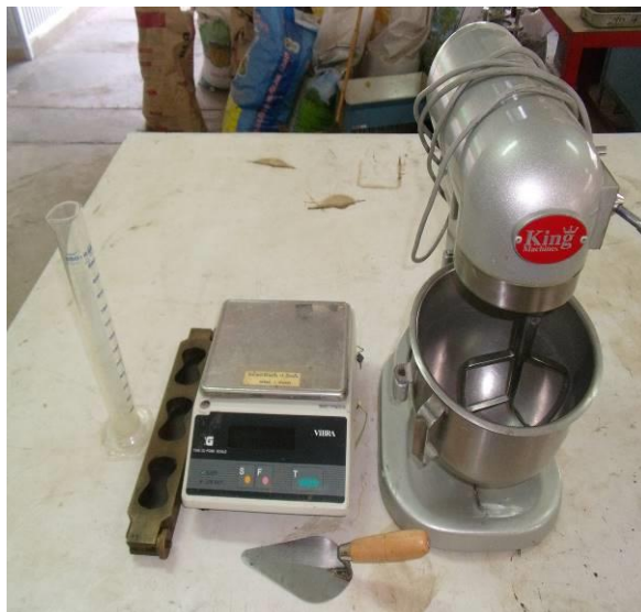
อุปกรณ์สำหรับการทดสอบการแรงดึงของซีเมนต์เพสต์และซีเมนต์มอร์ต้า
