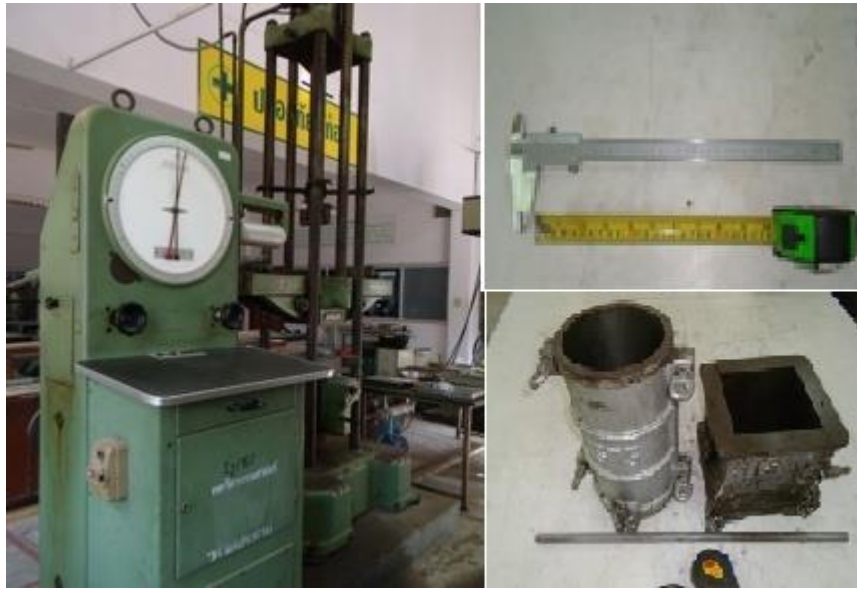
อุปกรณ์สำหรับการทดสอบแรงยึดเหนี่ยวของคอนกรีตต่อเหล็กเสริม
