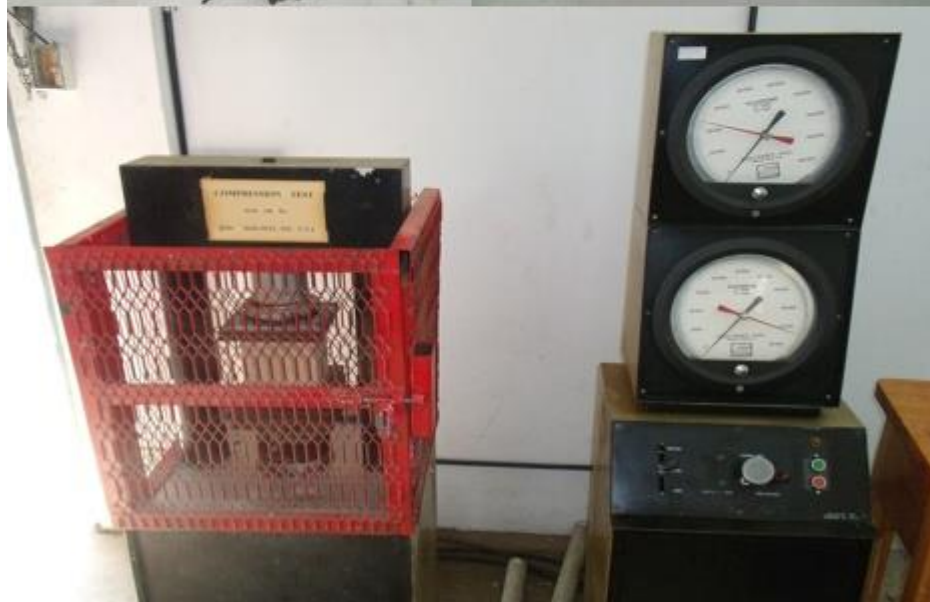
อุปกรณ์สำหรับการทดสอบกำลังรับแรงอัดของคอนกรีต
