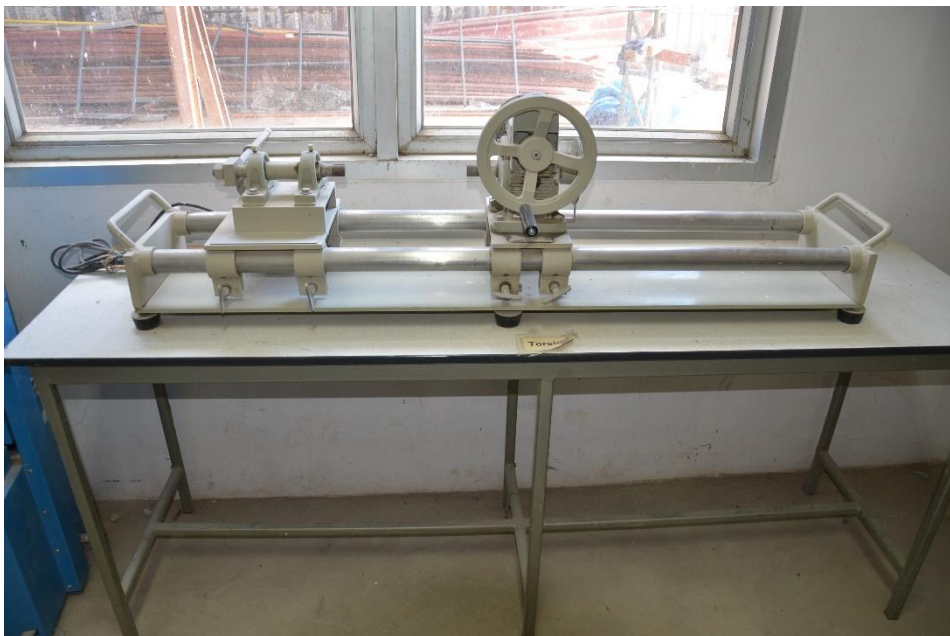
อุปกรณ์สำหรับการทดสอบแรงบิดของเหล็กและเหล็กหล่อ
