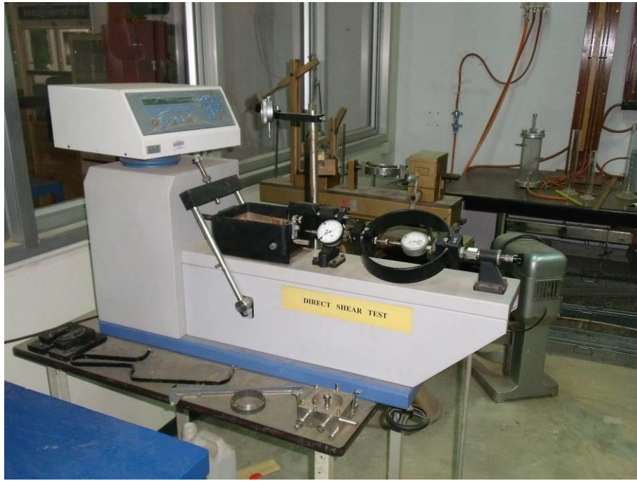
อุปกรณ์การทดสอบหาค่ารับแรงเฉือนของดินแบบ Direct Shear
