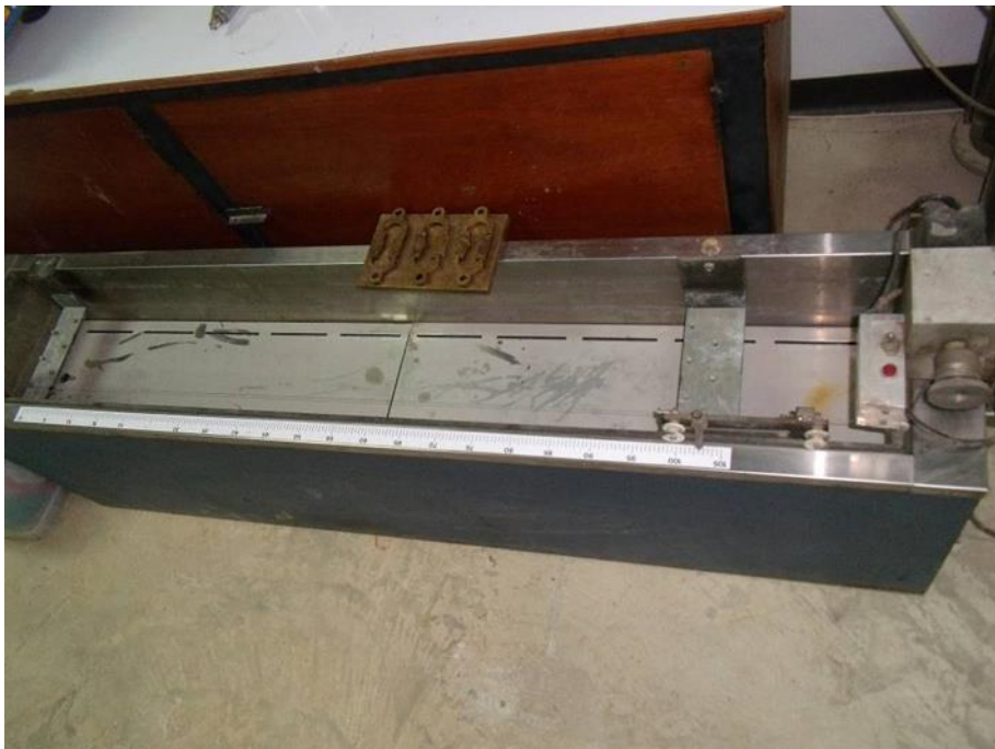
อุปกรณ์สำหรับการทดสอบความยืดดึงของวัสดุพิวเมน
