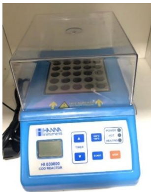
13. เครื่องวัดค่า COD พร้อมให้ความร้อน (COD reactor)
