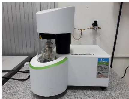
6. เครื่องวิเคราะห์การเปลี่ยนแปลงน้ำหนักของสารโดยอาศัยคุณสมบัติทางความร้อน (Thermogravimetric Analysis (TGA))
